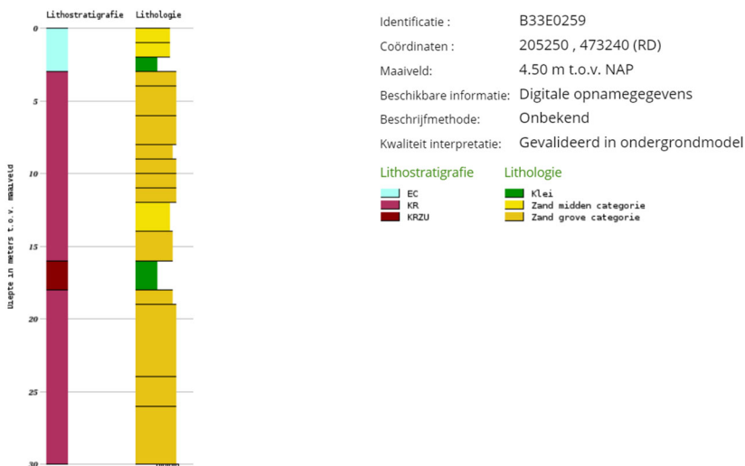
Afbeelding 2.1: Boorbeschrijving boring B33E0259 (bron: Dinoloket)
