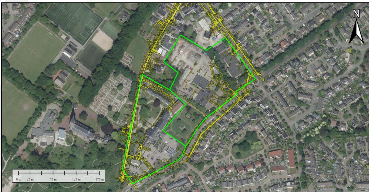
Figuur 11. Weergave van de bodemroerende werkzaamheden als gevolg van de aanleg van riolering en datatransport (geel). Hierbij is een buffer in acht genomen van 0,50 meter aan weerszijden van de betreffende leiding- en kabeltracés. Bron satellietbeeld: World Imagery.
