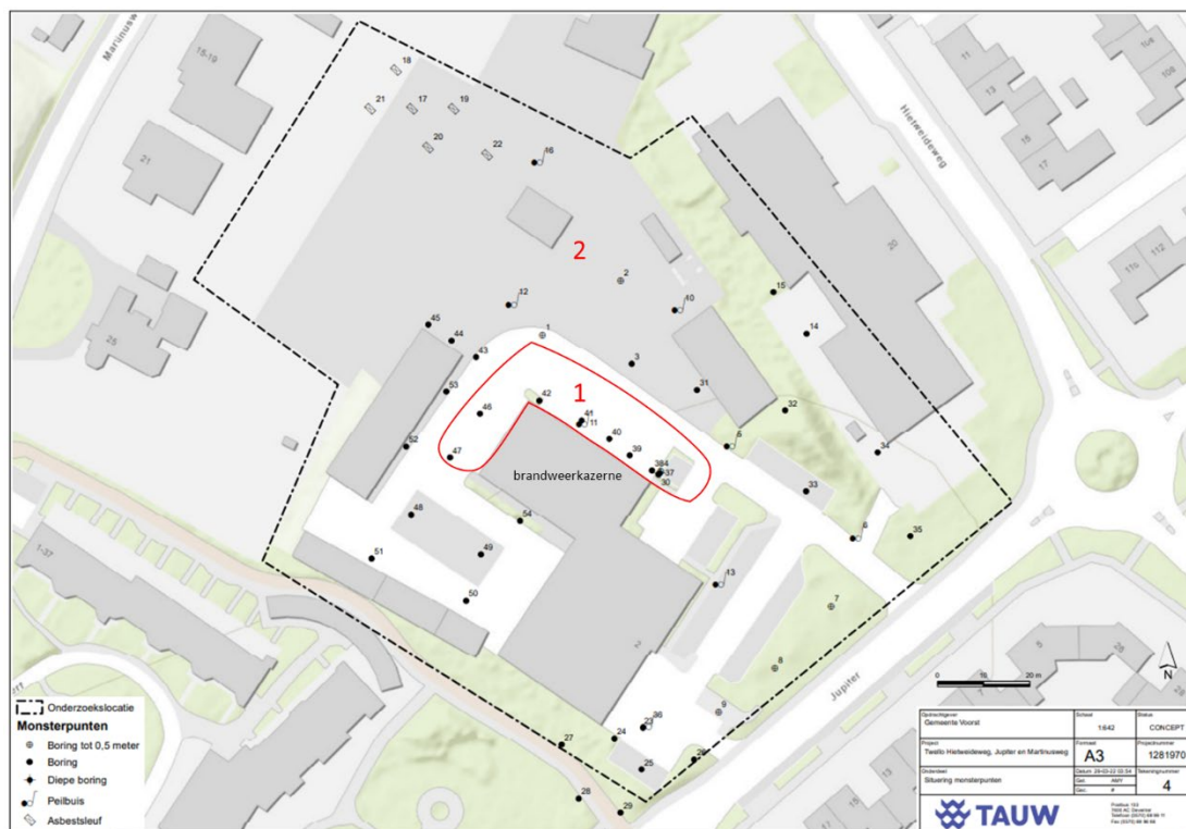
Figuur 2.1 Deelgebieden 1 (noord en west van voormalige brandweerkazerne) en 2 (overig gebied binnen onderzoekslocatie) voor risicobeoordeling
