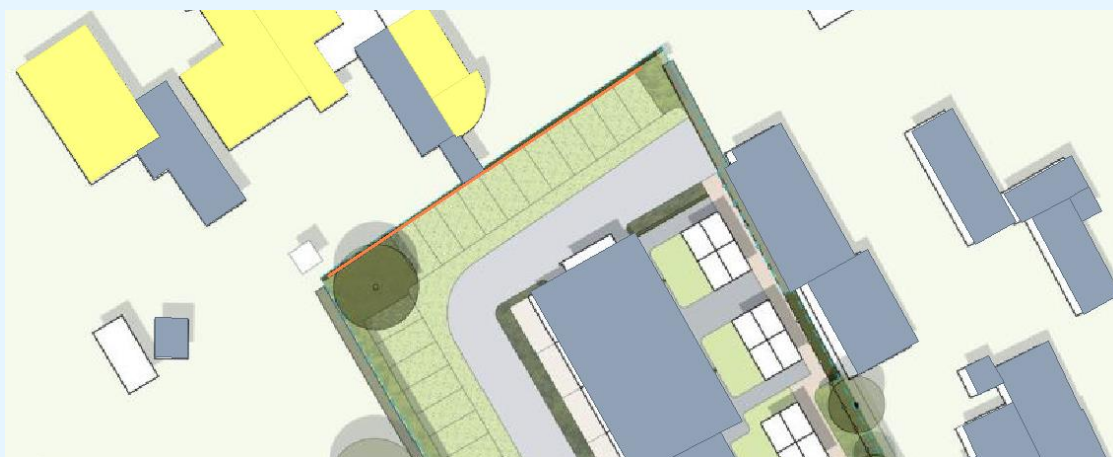
figuur 2: plaatsing geluidsschermb (oranje, 2 meter hoogte)
