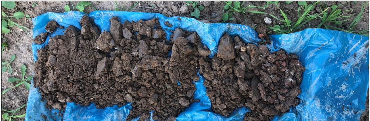
Boring 3: 0-85 cm -Mv. Drie keer gestaakt op zeer vast puin
