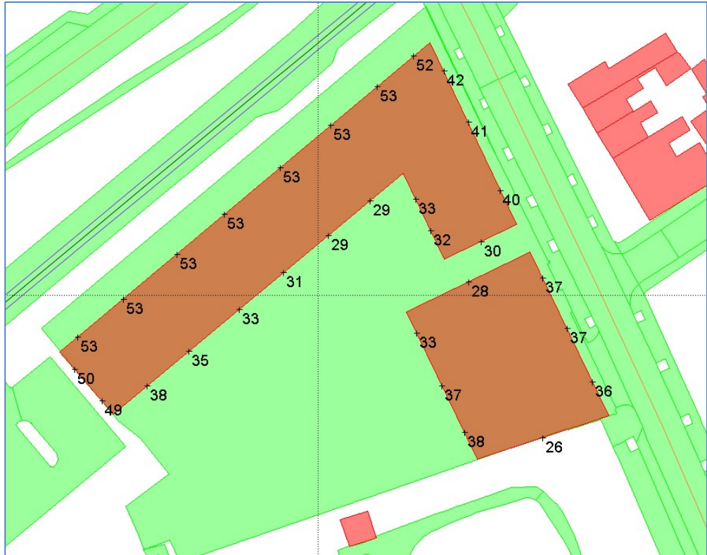
Figuur 4 Hoogst berekende geluidbelasting vanwege de Burgemeester Bonhofflaan inclusief aftrek conform artikel 110g Wgh
