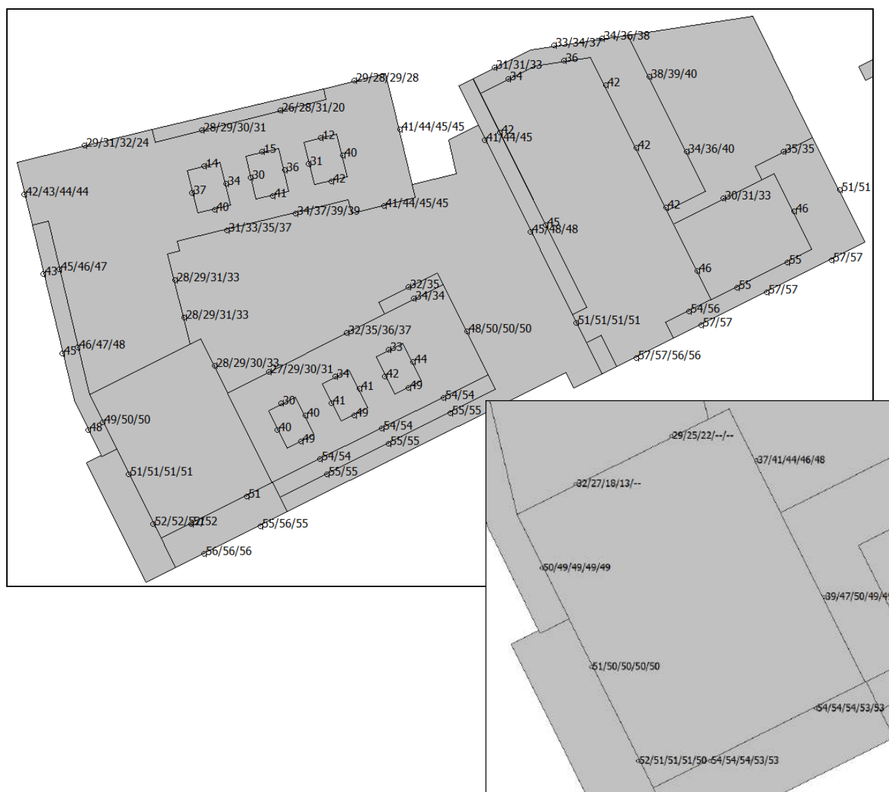
Figuur 5.1: Geluidbelasting ten gevolge van wegverkeer op de Nieuwe Tielseweg (inclusief aftrek); boven: begane grond t/m 3 e verdieping, onder: 4 e verdieping t/m 8 e verdieping (toren)
