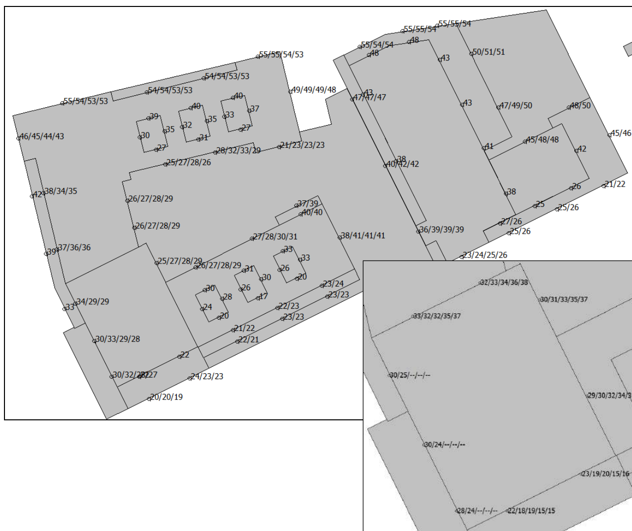
Figuur 5.3: Geluidbelasting ten gevolge van wegverkeer op de Tinnegieter; boven: begane grond t/m 3 e verdieping, onder: 4 e verdieping t/m 8 e verdieping (toren)
