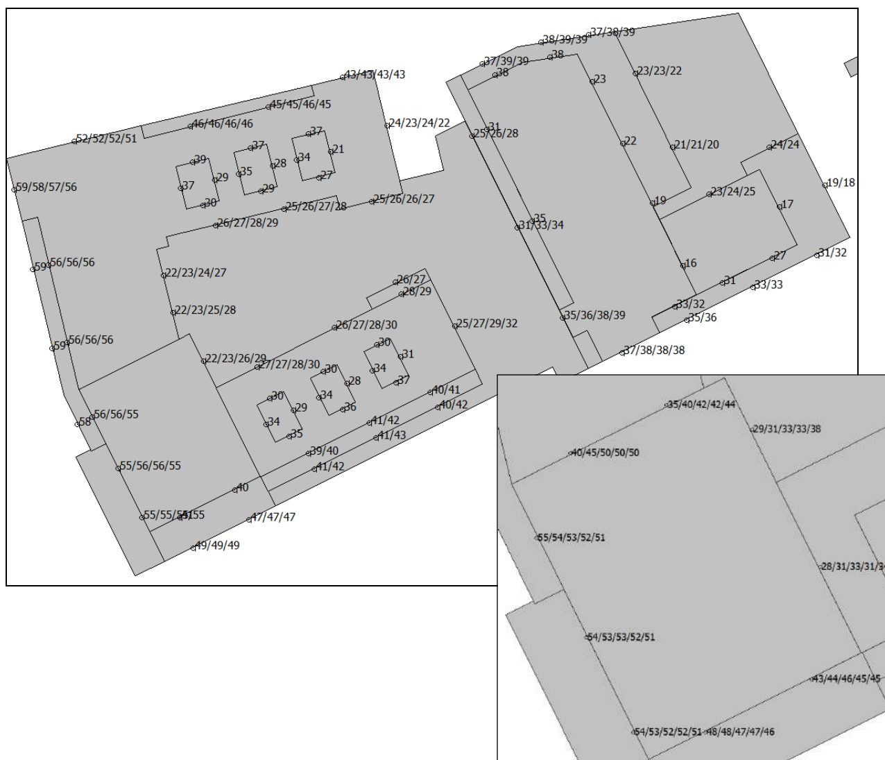
Figuur 5.2: Geluidbelasting ten gevolge van wegverkeer op de Heiligestraat; boven: begane grond t/m 3 e verdieping, onder: 4 e verdieping t/m 8 e verdieping (toren)
