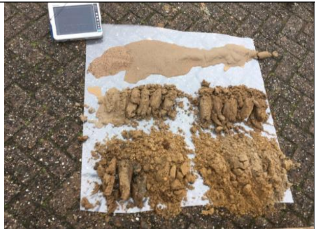
Boring 4; uitgelegd van rechtsonder naar linksboven. Onder de klinkers bevindt zich een pakket ophoogzand, met daaronder een restant van de voormalige bouwvoor, oeverafzettingen en beddingafzettingen, waarvan de basis duidelijk grover is dan de top.
