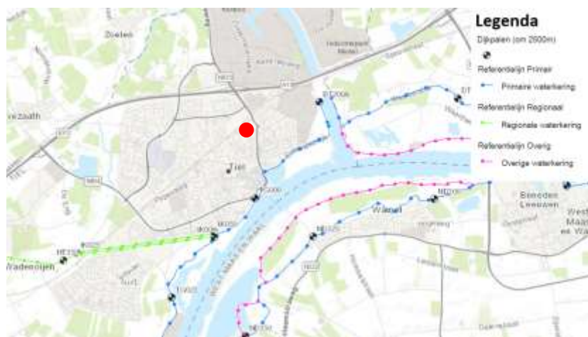
Figuur 2-11: Overzicht waterkeringen rondom Tiel
