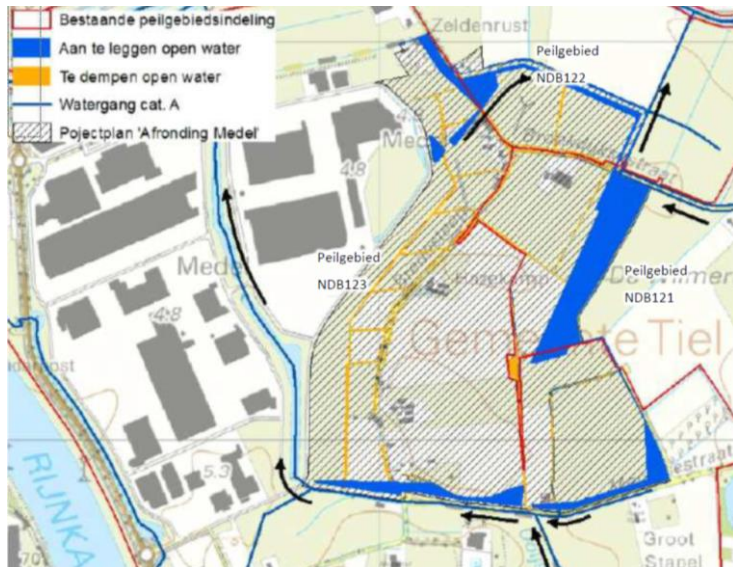
Afbeelding 7.2.: Afwateringsstructuur Bedrijvenpark Medel Afronding (Witteveen&Bos, 2015)
