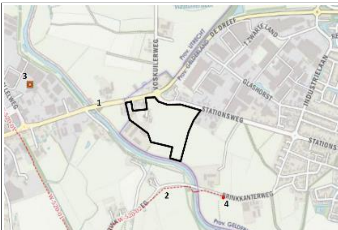
Figuur 15 – Ligging van plangebied (zwart) ten opzichte van risicobronnen: provinciale weg N224 (1), hogedruk aardgas-transportleiding (2), Van Appeldoorn Chemical Logistics (3) en gasdrukmeet- en regelstation (4). (bron: Antea Group)
