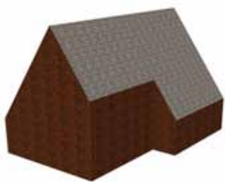
Eén hap uit gevel en dak, dak kan doorlopen als ander materiaal.
