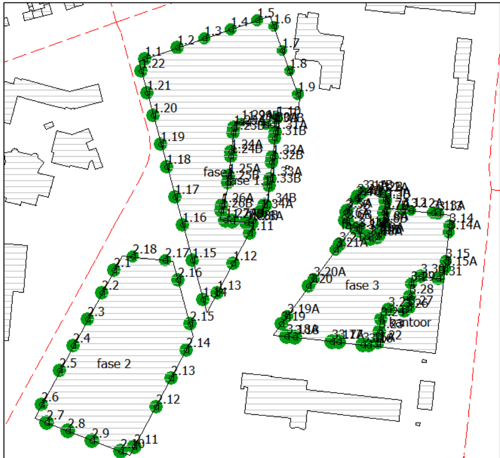
Berekende geluidbelasting vanwege de snelwegen exclusief aftrek conform artikel 110g Wgh
