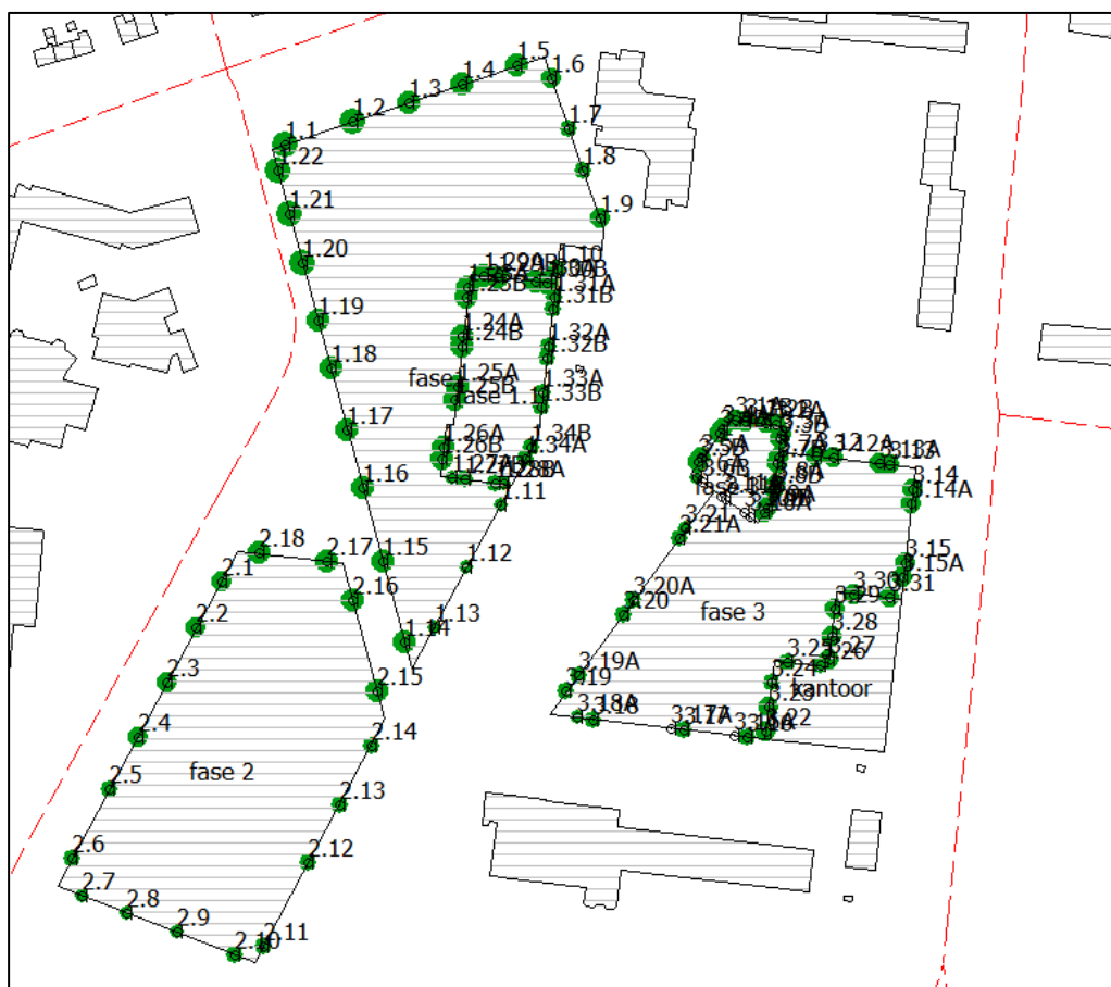
Berekende geluidbelasting per toetspunt ten gevolge van de overige niet-gezoneerde wegen gezamenlijk inclusief aftrek conform artikel 110g Wgh
