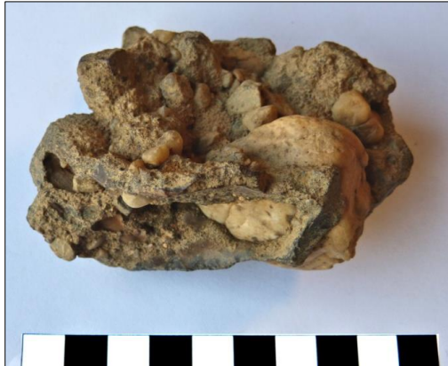
Afbeelding 6 Metaalslak met forse fragmenten grind
