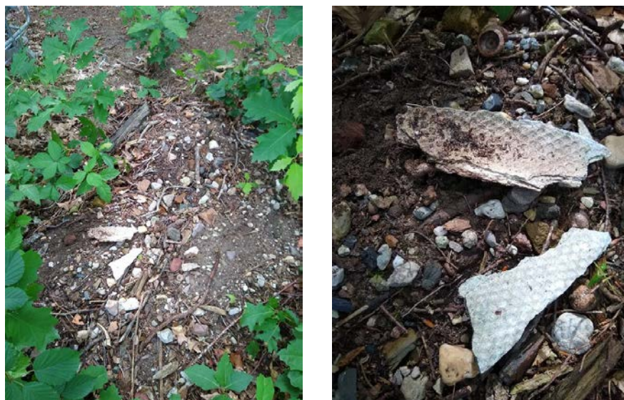
Figuur 2.2 Depot(je) puin met twee stukjes asbestverdacht materiaal
