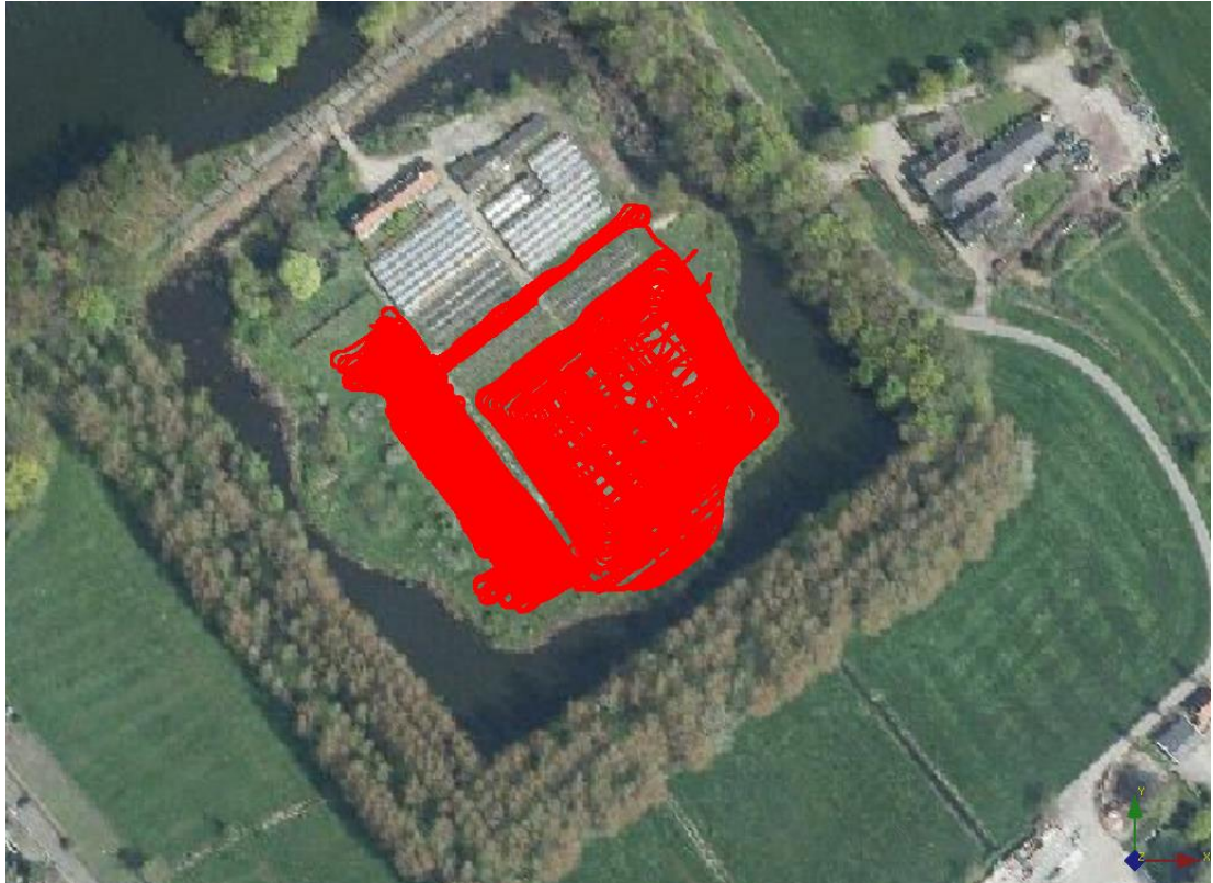
Afbeelding 5: surveylijnen grondradar in rood
