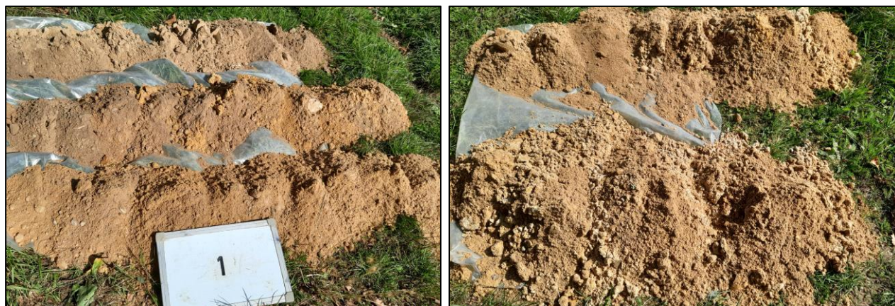
Afbeelding 4: Profielboring 1. Linker foto van 0,0 (links boven) tot 3,0 m-mv (rechts onder) en rechter foto van 3,0 (links boven) tot 5,0 m-mv (rechts onder).
