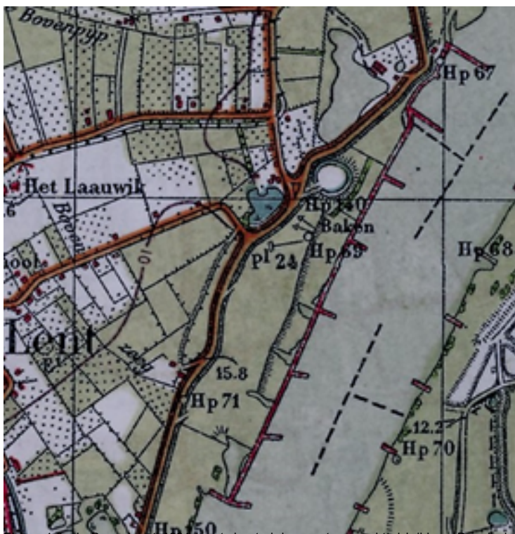
Figuur 4.3: de Bonnekaart 1931 toont de strekdam met een achttal kribben. De winningskuilen zijn in vergelijking met de situatie in 1906 vergroot (bron: www.watwaswaar.nl )
