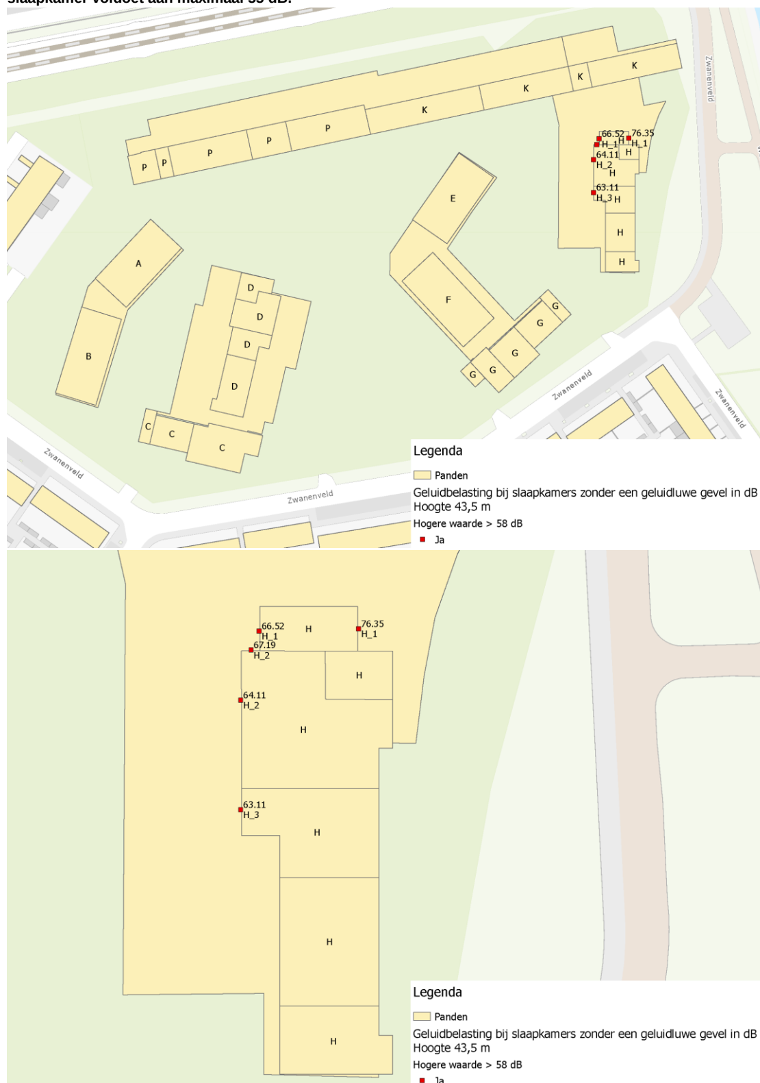
Figuur 3o: Ligging slaapkamers op de vijftiende bouwlaag op 43,5 meter met aangegeven of de geluidbelasting op de slaapkamer voldoet aan maximaal 55 dB.
