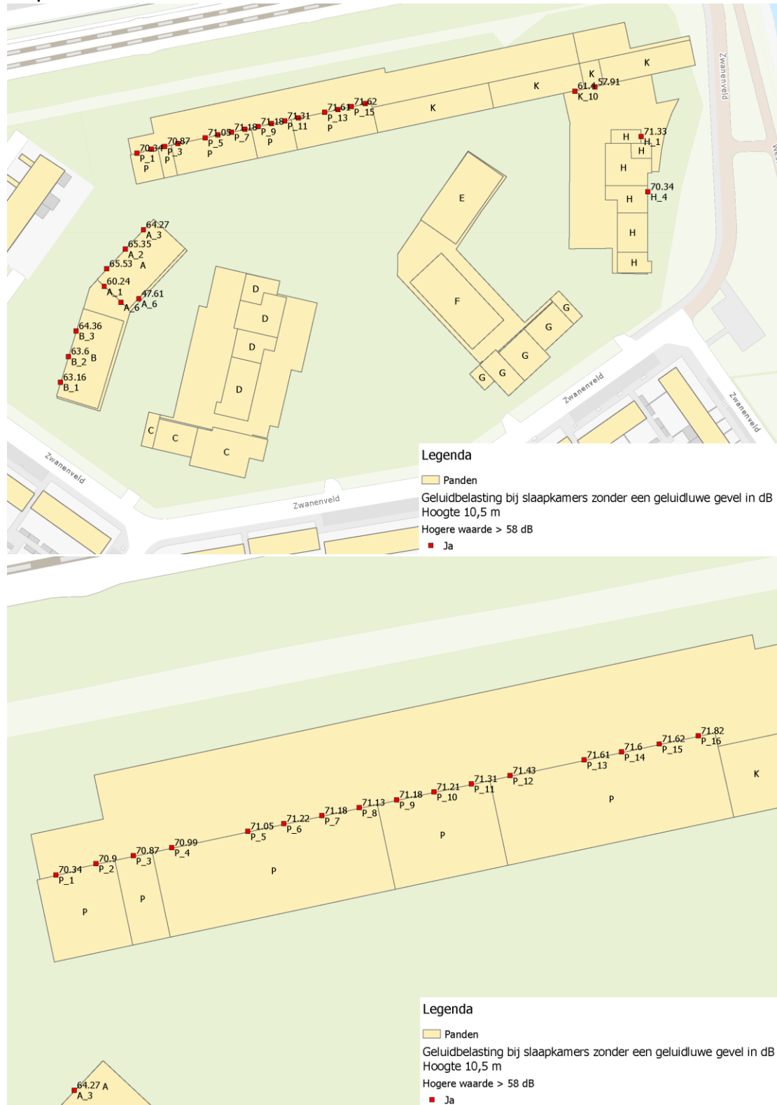
Figuur 3d: Ligging slaapkamers op de vierde bouwlaag op 10,5 meter met aangegeven of de geluidbelasting op de slaapkamer voldoet aan maximaal 55 dB.
