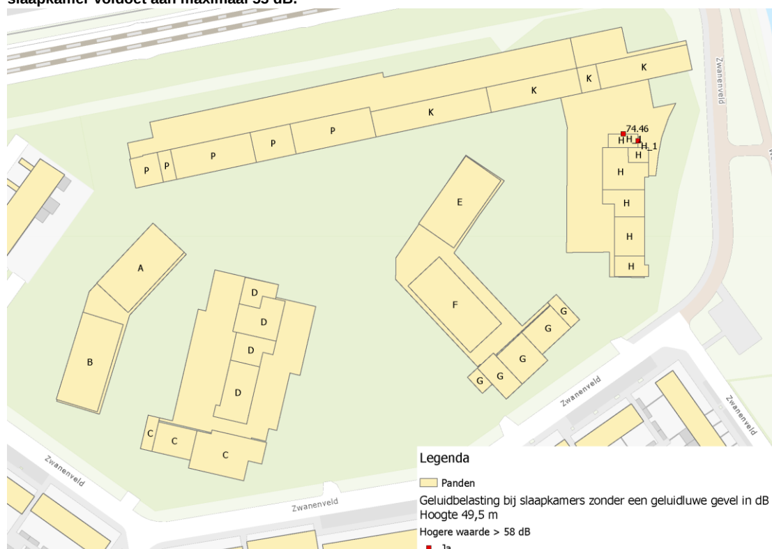
Figuur 3q: Ligging slaapkamers op de zeventiende bouwlaag op 49,5 meter met aangegeven of de geluidbelasting op de slaapkamer voldoet aan maximaal 55 dB.
