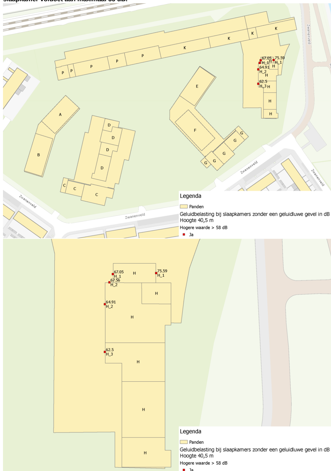
Figuur 3n: Ligging slaapkamers op de veertiende bouwlaag op 40,5 meter met aangegeven of de geluidbelasting op de slaapkamer voldoet aan maximaal 55 dB.
