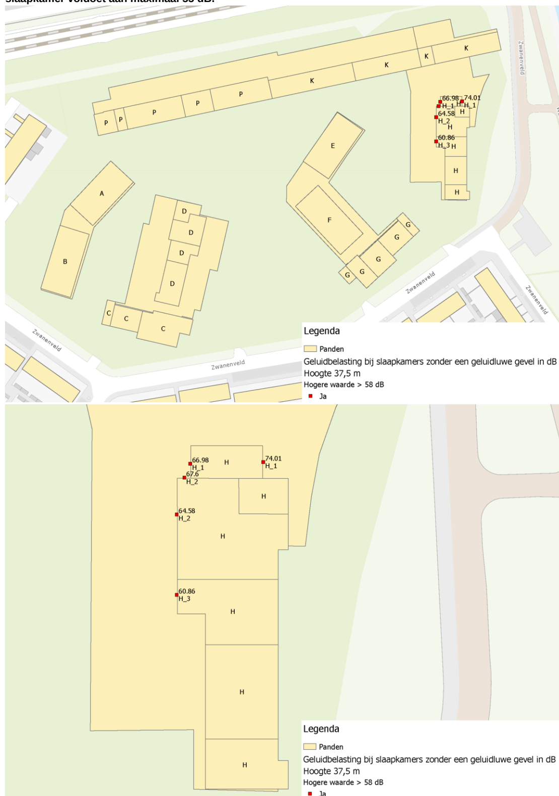
Figuur 3m: Ligging slaapkamers op de dertiende bouwlaag op 37,5 meter met aangegeven of de geluidbelasting op de slaapkamer voldoet aan maximaal 55 dB.
