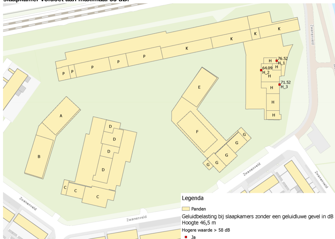
Figuur 3q: Ligging slaapkamers op de zeventiende bouwlaag op 49,5 meter met aangegeven of de geluidbelasting op de slaapkamer voldoet aan maximaal 55 dB.
