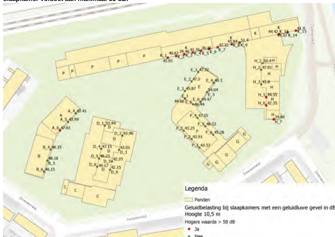
Figuur 2d: Ligging slaapkamers op de vierde bouwlaag op 10,5 meter met aangegeven of de geluidbelasting op de slaapkamer voldoet aan maximaal 55 dB.
