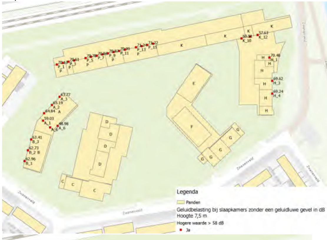
Figuur 3c1: Ligging slaapkamers op de derde bouwlaag op 7,5 meter met aangegeven of de geluidbelasting op de slaapkamer voldoet aan maximaal 55 dB.
