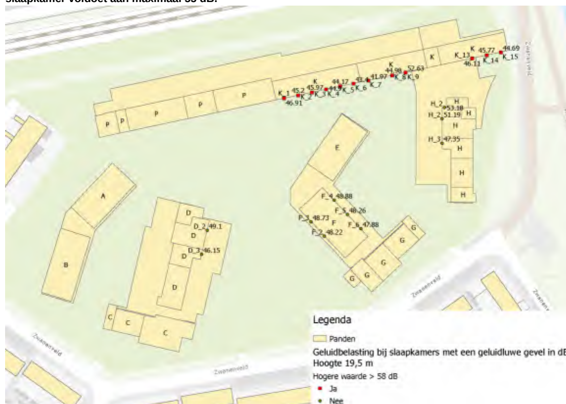
Figuur 2h: Ligging slaapkamers op de achtste bouwlaag op 22,5 meter met aangegeven of de geluidbelasting op de slaapkamer voldoet aan maximaal 55 dB.
