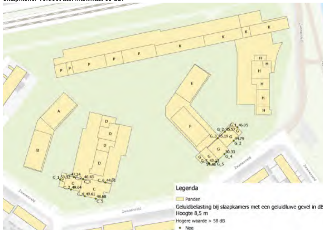
Figuur 2d: Ligging slaapkamers op de vierde bouwlaag op 10,5 meter met aangegeven of de geluidbelasting op de slaapkamer voldoet aan maximaal 55 dB.
