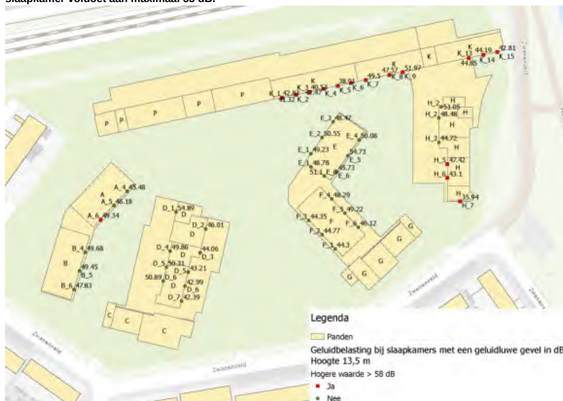
Figuur 2f: Ligging slaapkamers op de zesde bouwlaag op 16,5 meter met aangegeven of de geluidbelasting op de slaapkamer voldoet aan maximaal 55 dB.
