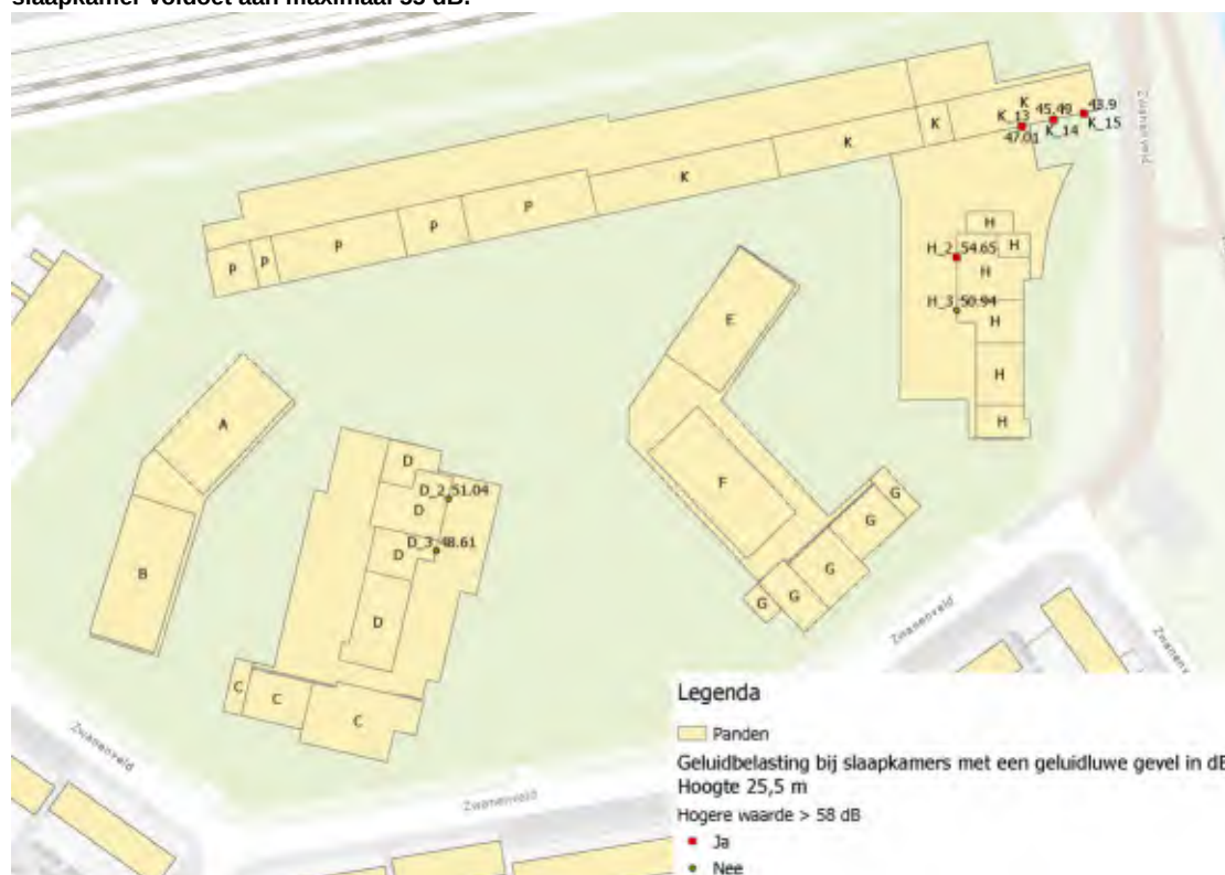
Figuur 2j: Ligging slaapkamers op de tiende bouwlaag op 28,5 meter met aangegeven of de geluidbelasting op de slaapkamer voldoet aan maximaal 55 dB.
