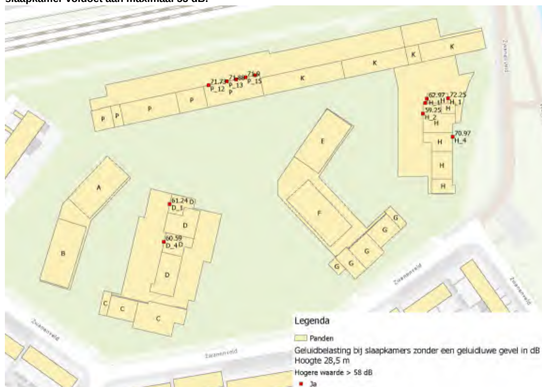
Figuur 3j: Ligging slaapkamers op de tiende bouwlaag op 28,5 meter met aangegeven of de geluidbelasting op de slaapkamer voldoet aan maximaal 55 dB.
