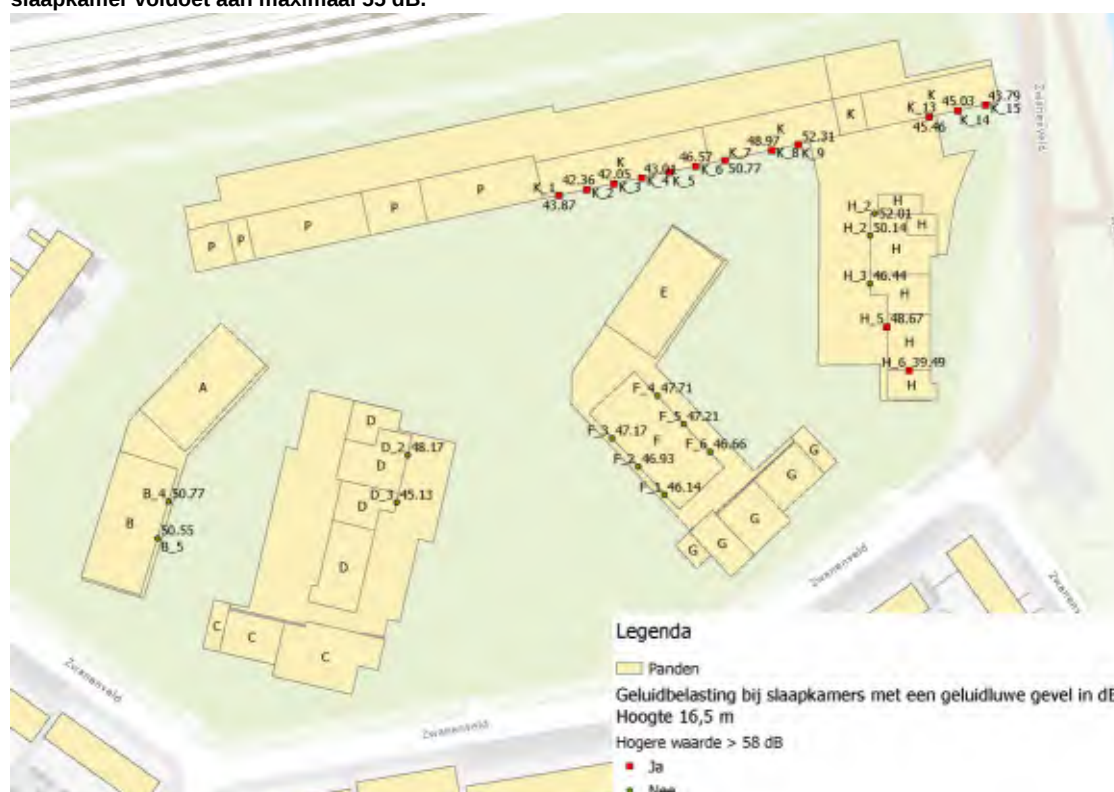
Figuur 2f: Ligging slaapkamers op de zesde bouwlaag op 16,5 meter met aangegeven of de geluidbelasting op de slaapkamer voldoet aan maximaal 55 dB.
