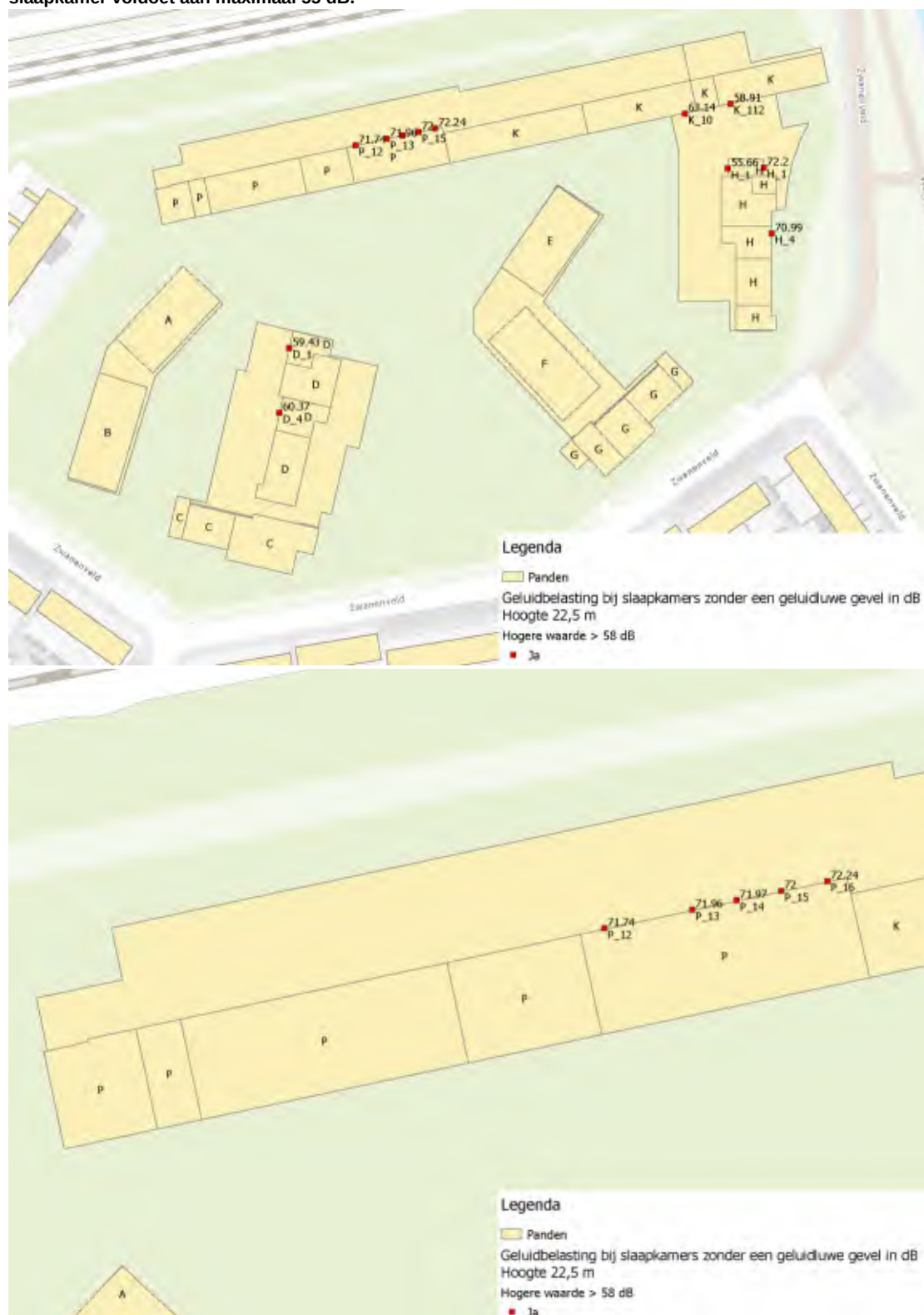
Figuur 3h: Ligging slaapkamers op de achtste bouwlaag op 22,5 meter met aangegeven of de geluidbelasting op de slaapkamer voldoet aan maximaal 55 dB.
