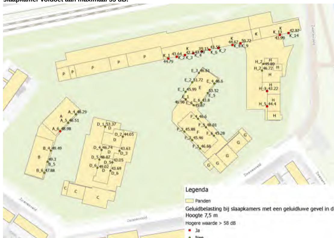
Figuur 2c1: Ligging slaapkamers op de derde bouwlaag op 7,5 meter met aangegeven of de geluidbelasting op de slaapkamer voldoet aan maximaal 55 dB.
