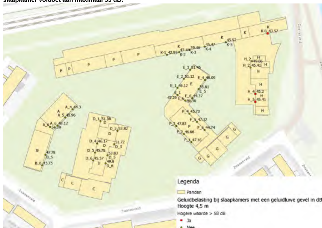
Figuur 2b1: Ligging slaapkamers op de tweede bouwlaag op 4,5 meter met aangegeven of de geluidbelasting op de slaapkamer voldoet aan maximaal 55 dB.
