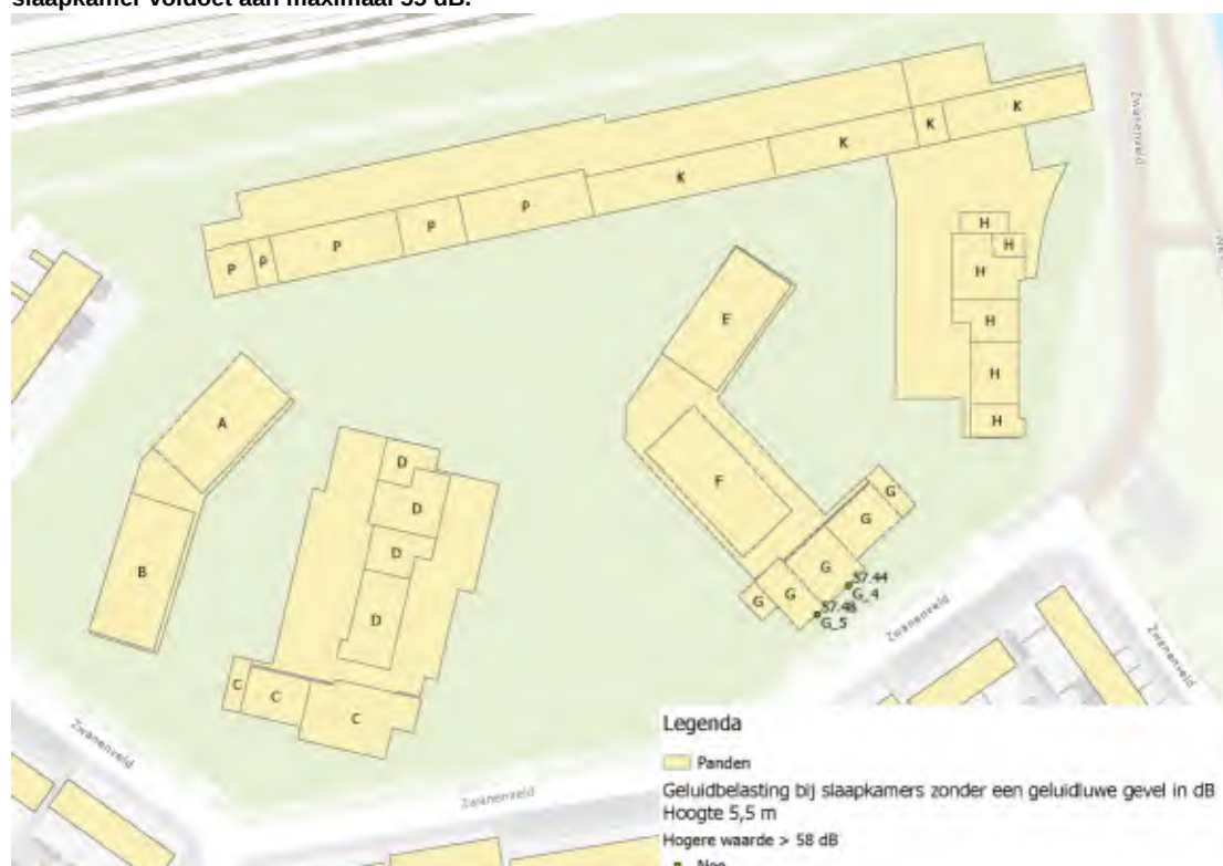
Figuur 3b2: Ligging slaapkamers op de tweede bouwlaag op 5,5 meter met aangegeven of de geluidbelasting op de slaapkamer voldoet aan maximaal 55 dB.
