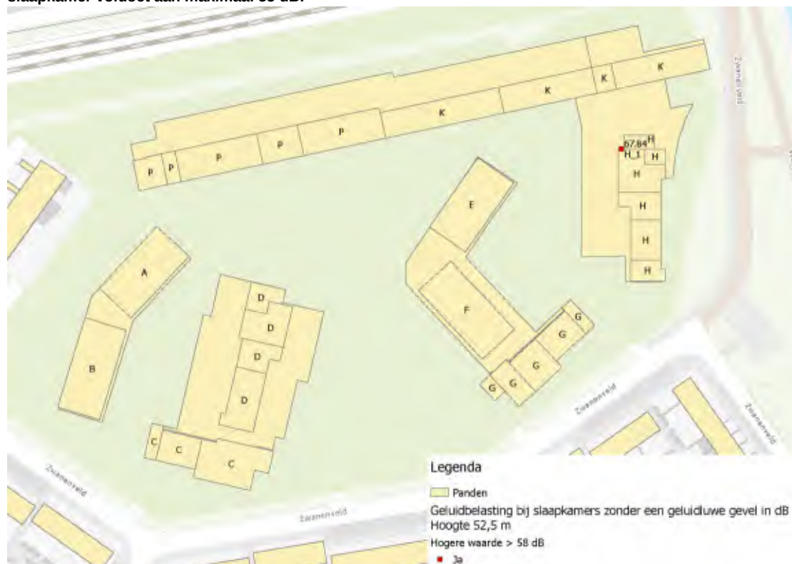
Figuur 3r: Ligging slaapkamers op de achttiende bouwlaag op 52,5 meter met aangegeven of de geluidbelasting op de slaapkamer voldoet aan maximaal 55 dB.
