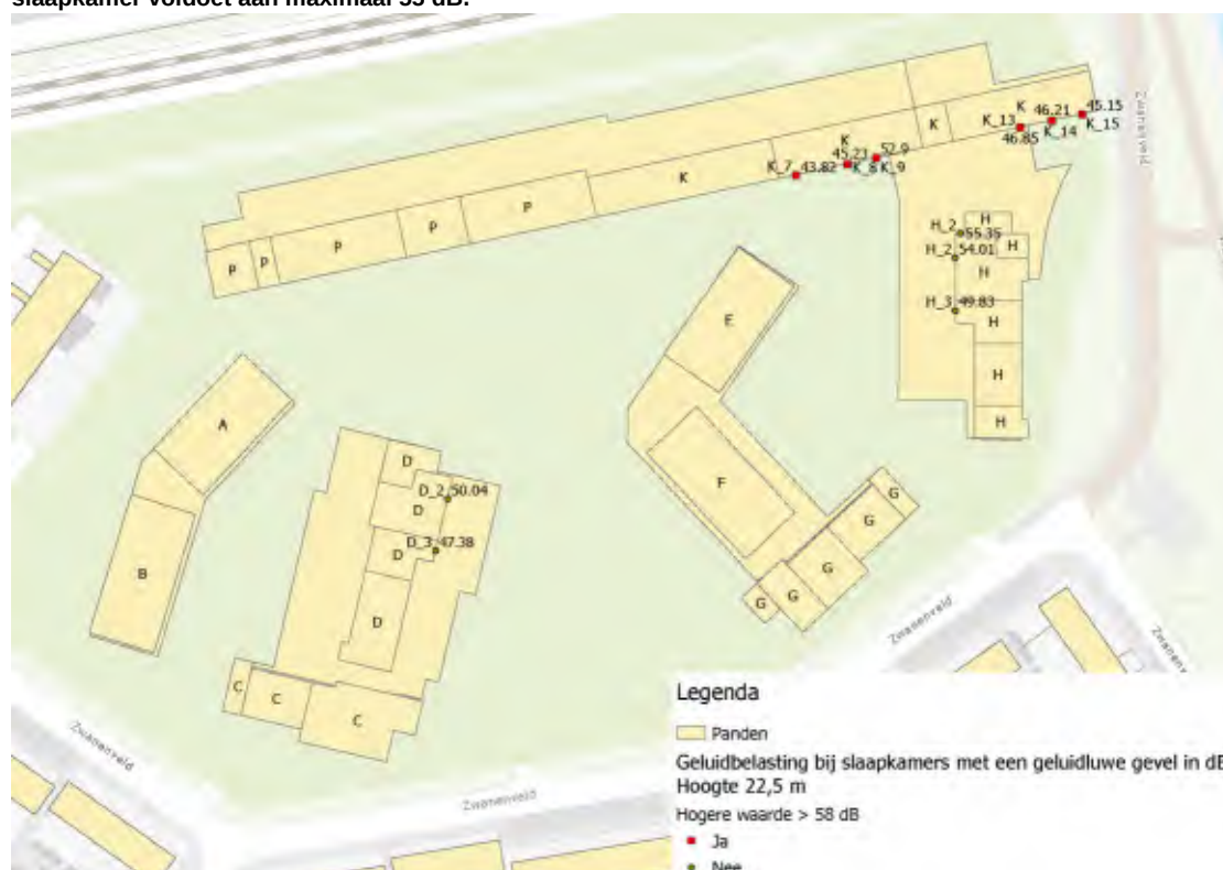
Figuur 2h: Ligging slaapkamers op de achtste bouwlaag op 22,5 meter met aangegeven of de geluidbelasting op de slaapkamer voldoet aan maximaal 55 dB.
