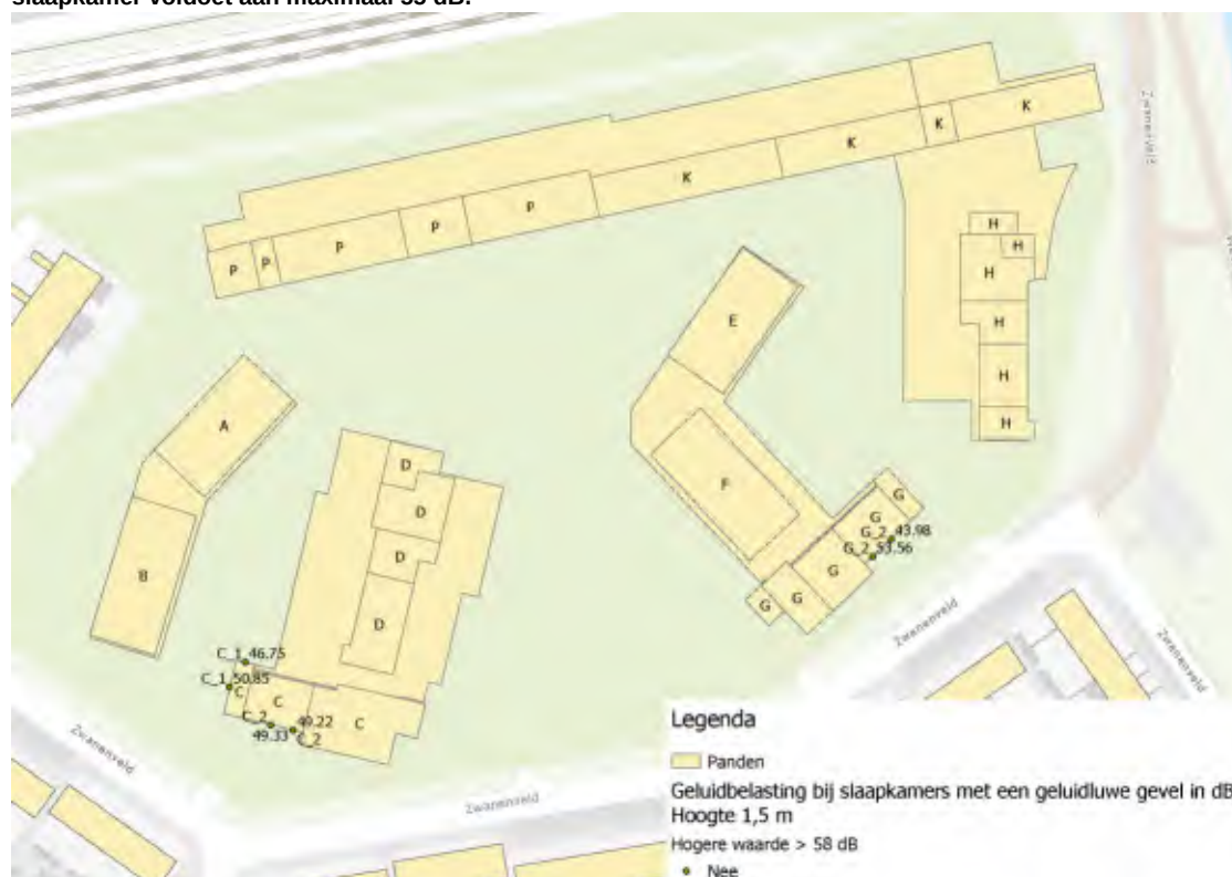
Figuur 2b1: Ligging slaapkamers op de tweede bouwlaag op 4,5 meter met aangegeven of de geluidbelasting op de slaapkamer voldoet aan maximaal 55 dB.
