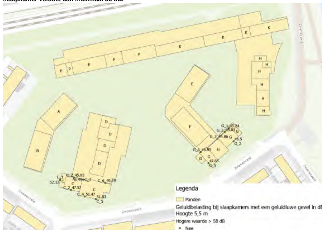
Figuur 2c1: Ligging slaapkamers op de derde bouwlaag op 7,5 meter met aangegeven of de geluidbelasting op de slaapkamer voldoet aan maximaal 55 dB.
