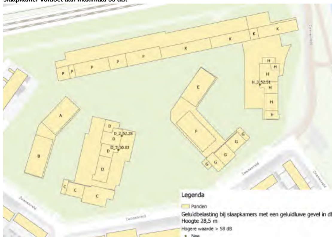
Figuur 2j: Ligging slaapkamers op de tiende bouwlaag op 28,5 meter met aangegeven of de geluidbelasting op de slaapkamer voldoet aan maximaal 55 dB.
