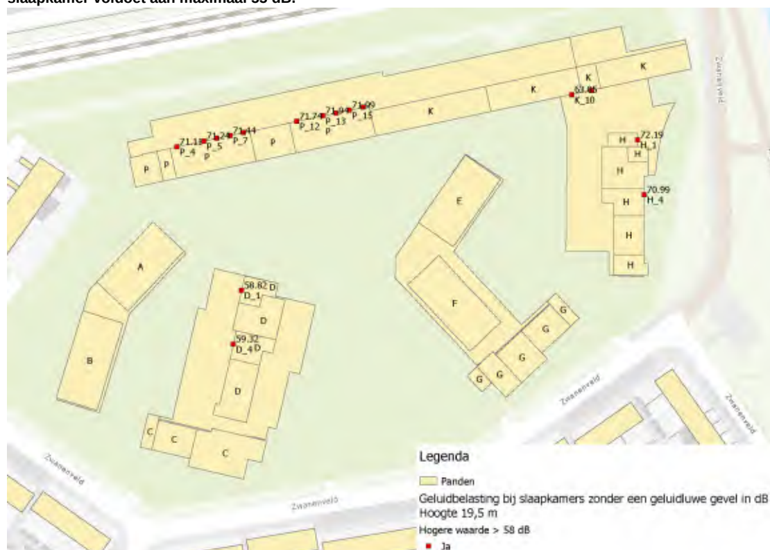
Figuur 3g: Ligging slaapkamers op de zevende bouwlaag op 19,5 meter met aangegeven of de geluidbelasting op de slaapkamer voldoet aan maximaal 55 dB.
