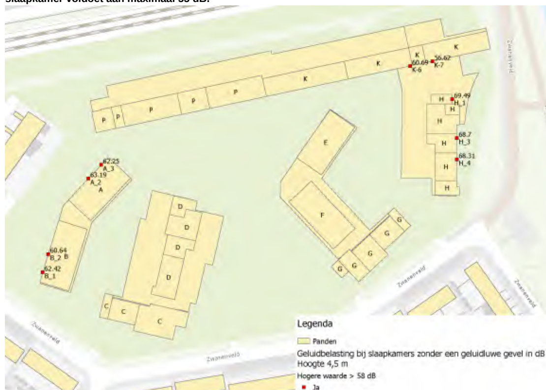
Figuur 3b2: Ligging slaapkamers op de tweede bouwlaag op 5,5 meter met aangegeven of de geluidbelasting op de slaapkamer voldoet aan maximaal 55 dB.
