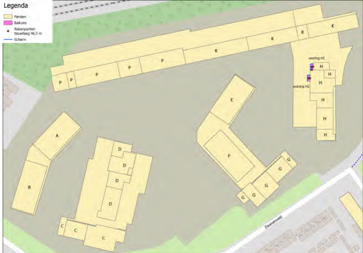
Figuur 1p: Balkon (H1/H2) met een beoogde geluidluwe gevel en buitenruimte op de 16 e bouwlaag (46,5 meter).
