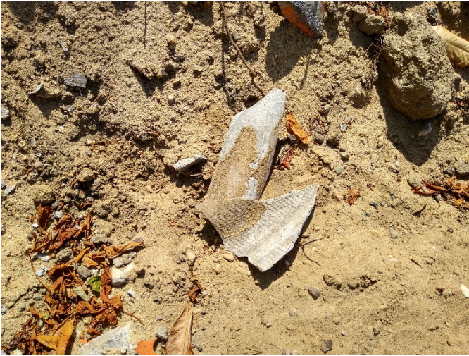
Foto 1. Bodemvreemd (asbest) materiaal op het maaiveld
