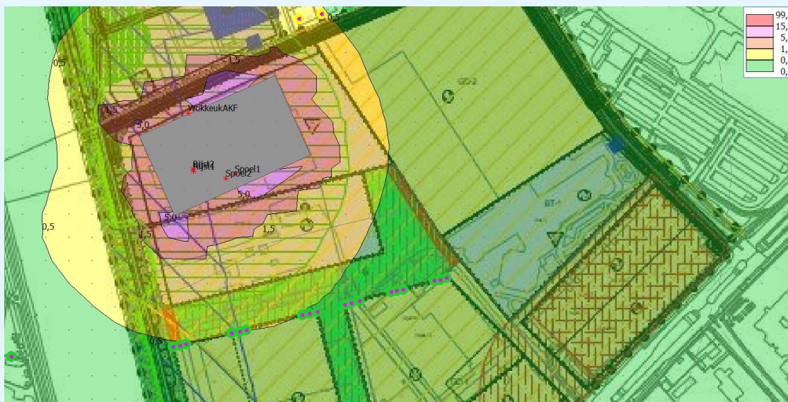
figuur 12: detail resultaten geurberekening Plaza Foods (98-percentiel), met actief koolfilter
