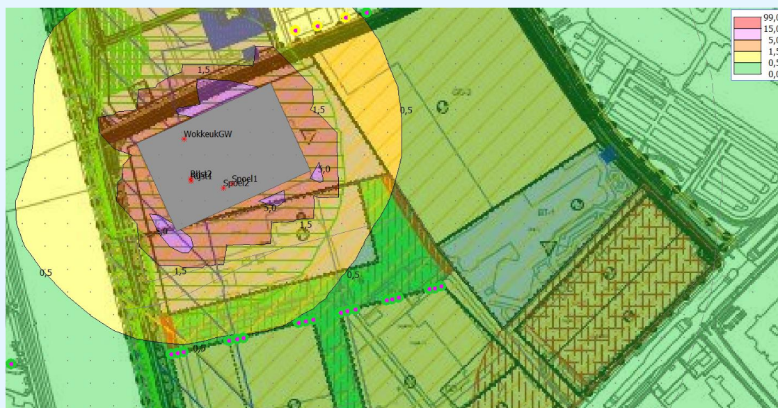
figuur 13: detail resultaten geurberekening Plaza Foods (98-percentiel), onder de bestaande maatwerkvoorschriften
