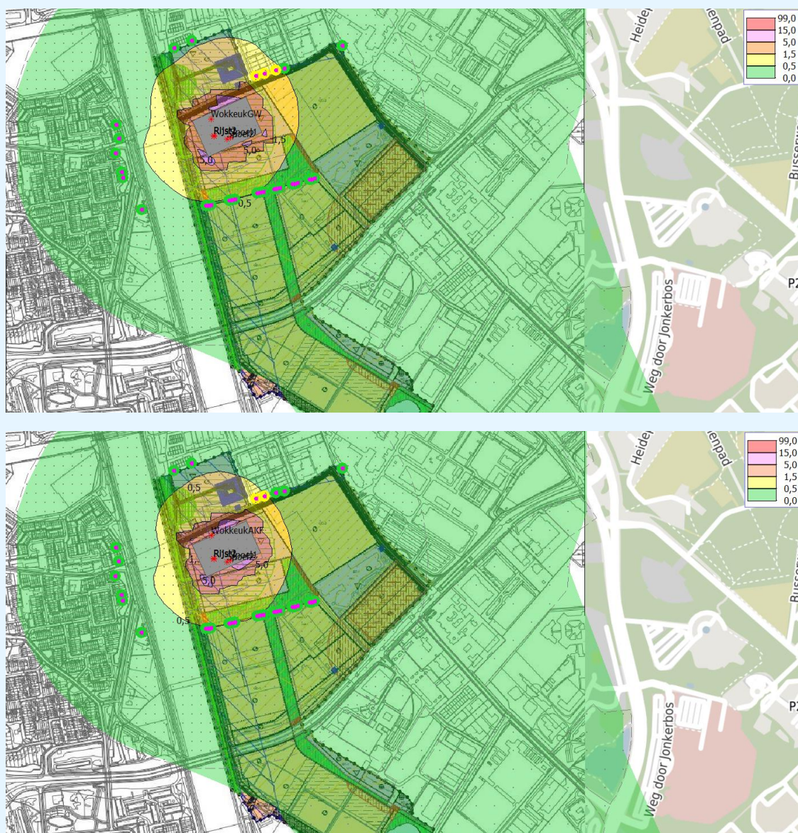
figuur 11: resultaten geurberekening (98-percentiel) voor Plaza Food conform maatwerkvoorschrift (boven) en met het plaatsen van een actief koolfilter op de afzuiging van de wokkeuken (onder)
