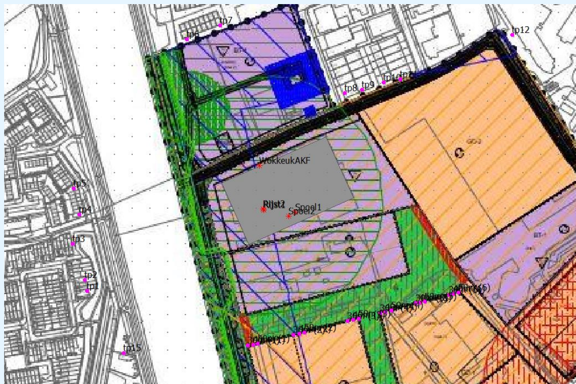
figuur 10: overzicht rekenmodel met de ligging van de rekenpunten rondom Plaza Foods en de gehanteerde rekenhoogten per rekenpunt
