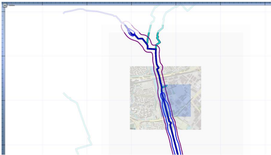
3.1 Figuur 3.1 Plaatsgebonden risico voor 8194_leiding-N-576-67-deel-1 van N.V. Nederlandse Gasunie
