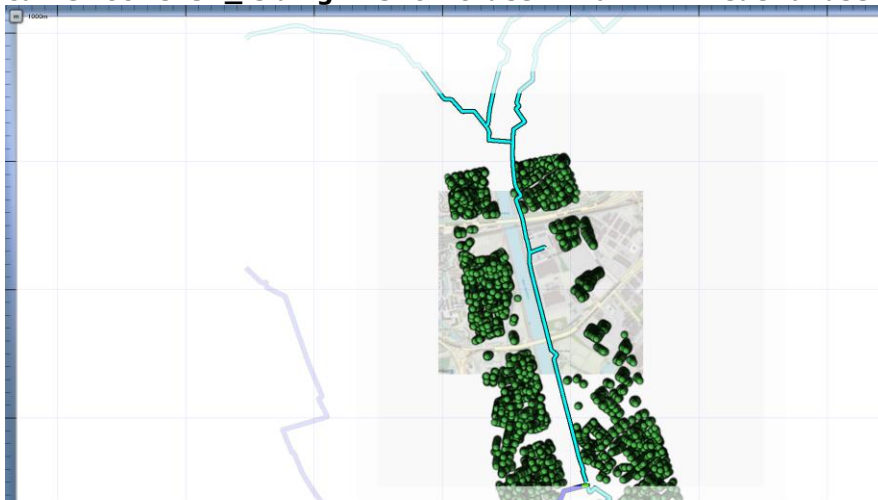
Figuur 4.5 Kilometer leiding behorende bij de maximale overschrijding van de FN-curve voor 8194_leiding-N-576-70-deel-1 van N.V. Nederlandse Gasunie
