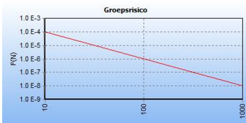
5.4 Figuur 5.4 FN curve voor 8194_leiding-N-576-69-deel-1 van N.V. Nederlandse Gasunie voor de kilometer tussen stationing 0.00 en stationing 120.00
