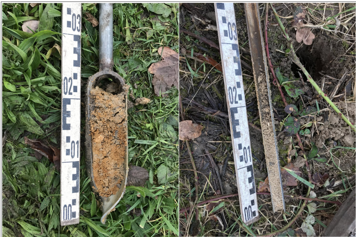
Figuur 12. Nijmegen, Hogelandseweg nabij nr. 100: Afbeelding met links de opgeboorde grond uit Boring 5 op een diepte van 70 centimeter beneden maaiveld (= onderkant van de Edelmanboor). De foto is van de laag met matig tot sterk grindhoudend, slecht gesorteerd, lemig zand (hellingafspoelingsafzettingen; fluvioglaciale afzetting van de permafrost uit het Weichselien). De laag van Wijchen is hier niet aanwezig. Rechts: de opgeboorde grond uit Boring 1 op een diepte van circa 100 centimeter beneden maaiveld (= onderkant gutsboor). De foto is van de zand- en grindige, laat pleistocene, fluviale terrasafzettingen (Formatie van Kreftenheye, waarschijnlijk onderdeel van Kreftenheye-4 terrasafzettingen). Deze afzettingen werden op basis van het bureauonderzoek in het plangebied verwacht (Hoofdstuk 2.2).
