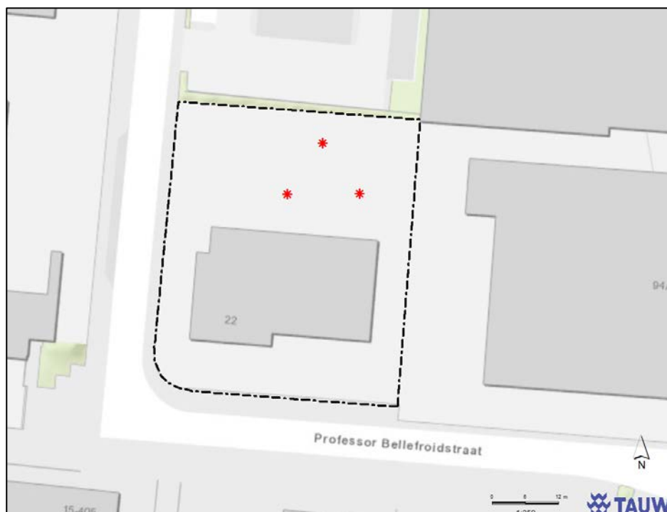
Figuur 2.3 Locatie met asbestspots in rood
