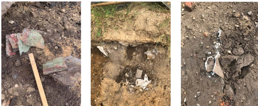
Figuur 2.4 Foto's van aangetroffen asbestverdacht materiaal
