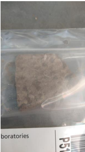
Foto 4: Asbestverdacht plaatmateriaal deellocatie A
