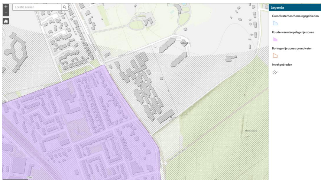
Figuur 2.2 | Boringsvrije zone en intrekgebied van het waterwingebied naast de locatie (bron: Provinciale kaarten Gelderland)
