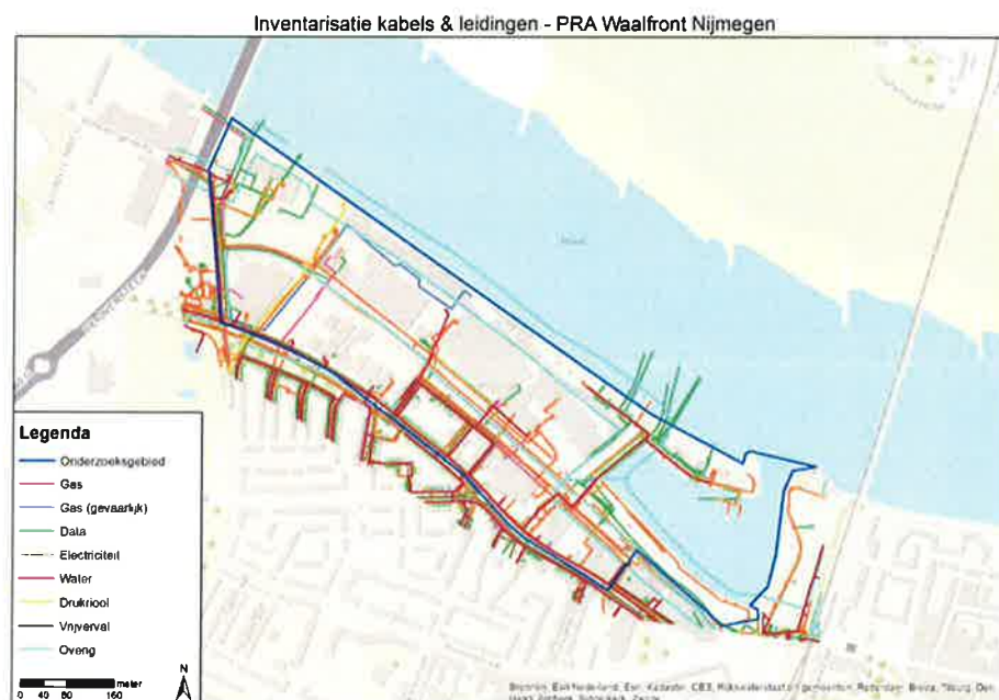
Afbeelding 7 kabels en leidingen informatie Waalfront
