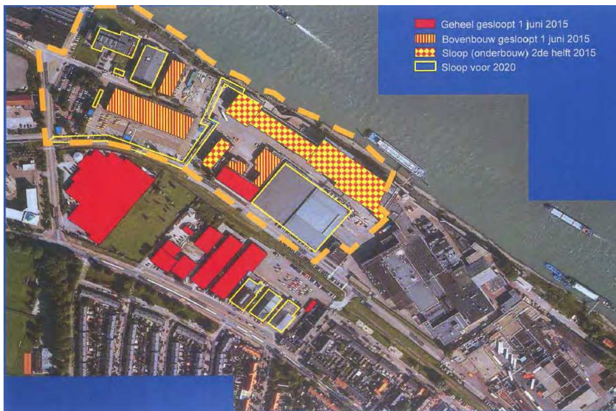
Figuur 2: gesloopte en te slopen gebouwen
