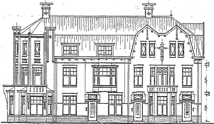
oorspronkelijke raamindeling gewijzigd en oorspronkelijk gemetselde borstwering van de balkons vervangen door metalen hekwerk
