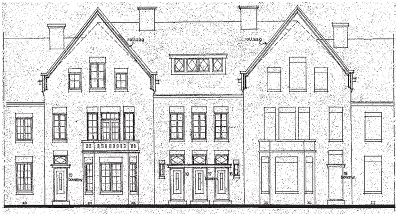
1921, architect: M.E. Veugelers oorspronkelijke raamindeling gewijzigd en oorspronkelijk gemetselde borstwering van de balkons vervangen door metalen hekwerk (1965)
