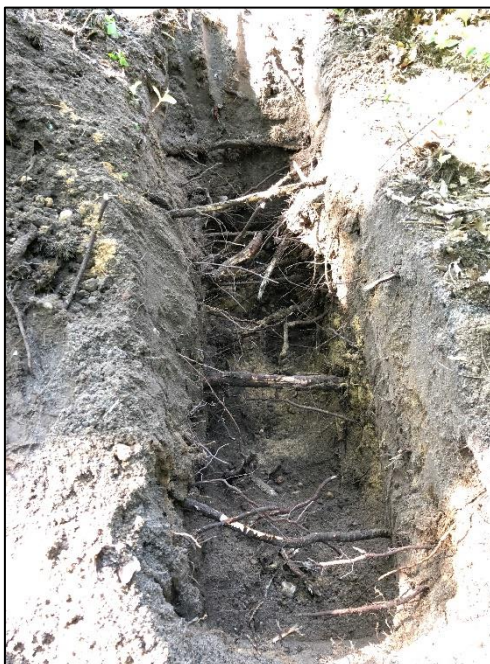
Figuur 9 Intensieve beworteling kastanje op ca. 5 m van de boom
