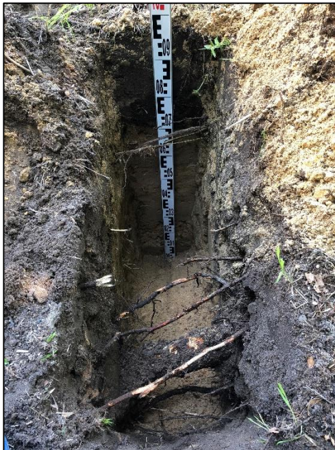
Figuur 6 Proefsleuf bij boom 1. Er is 1 dikke wortel van ca. 8 cm aangetroffen
