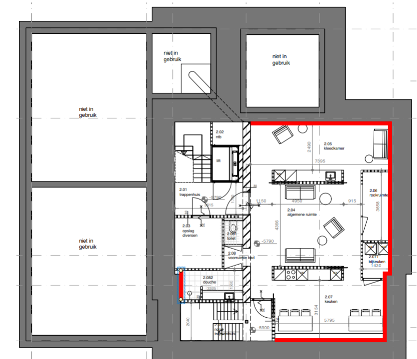
Figuur 8: voorzetwand verblijfsruimten verdieping -2
