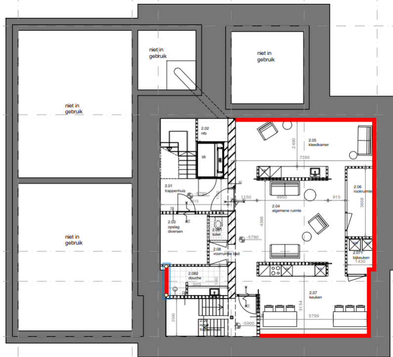
Figuur 8: voorzetwand verblijfsruimten verdieping -2
