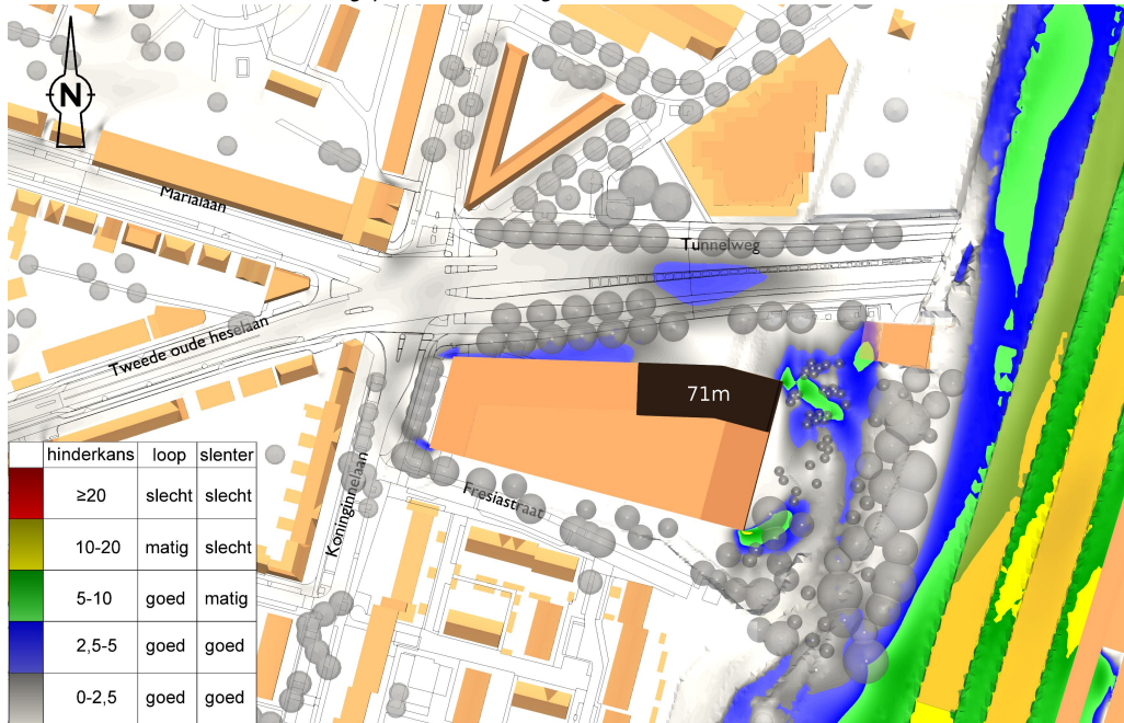
f3.2 Het te verwachten windklimaat in de geplande bebouwingssituatie
