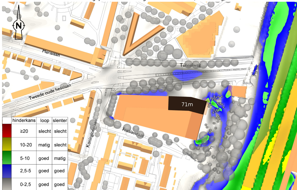
f3.4 Het te verwachten windklimaat in de geplande bebouwingssituatie met luifel (doorzichtig)
