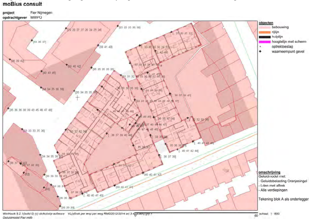
Figuur 8: Geluidsbelasting wegverkeer Oranjesingel blok A, Lden met aftrek, alle rekenhoogtes
