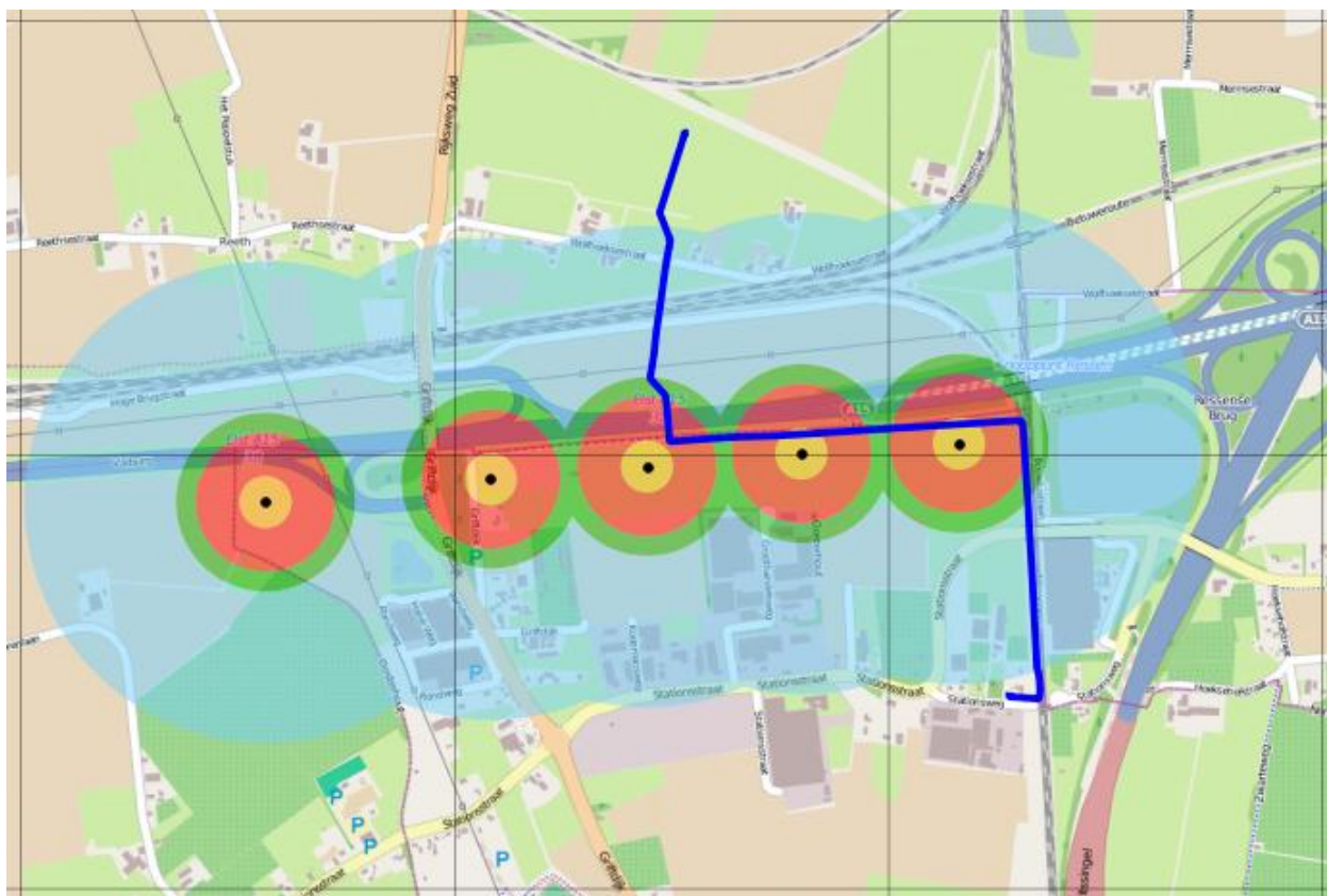
Figuur 2 Effectafstanden van de verschillende faalscenario's. Geel geeft het gebied aan waar gondelafworp invloed heeft op de faalkans van de leiding; rood het gebied voor mastbreuk; groen het gebied voor bladafworp bij nominaal toerental en lichtblauw het gebied voor bladafworp bij overtoeren.
