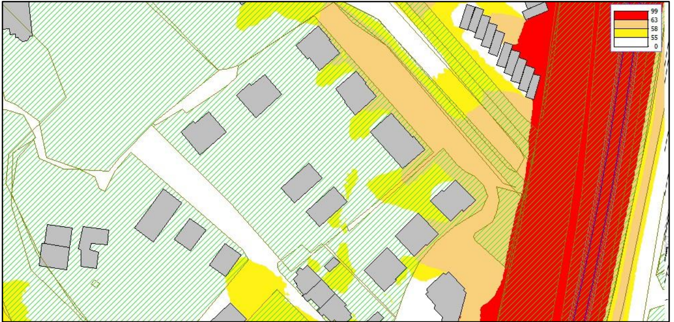
Figuur 6: Contourlijnen op 1,5 m boven maaiveld zonder geluidscherm
