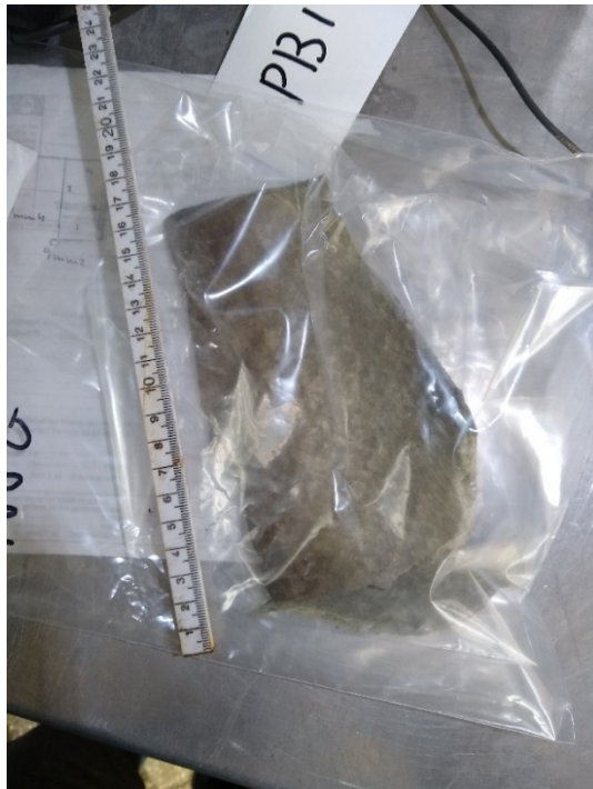
Figuur 4.1 Asbestverdacht materiaal op het maaiveld waargenomen naast de 'wasplaats' bij schuur 1
