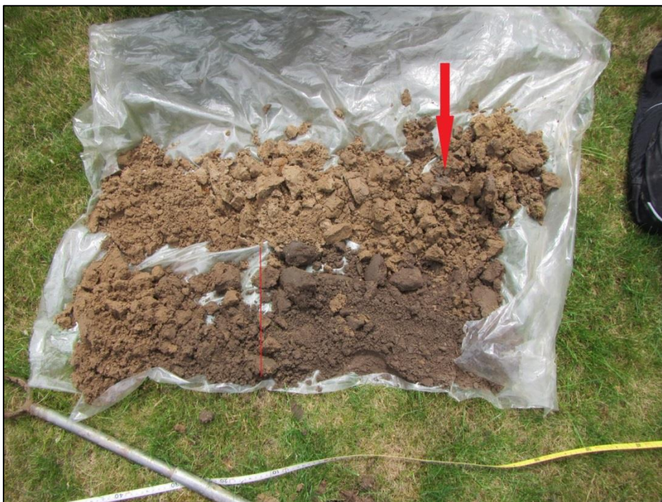
Afbeelding 3. Boring 4: onder een dikke omgewerkte bouwvoor (grijs) bevinden zich zandafzettingen met (bij de pijl) een dunne laag uiterst siltig zand met schelpresten
