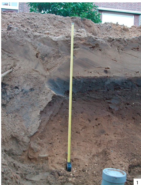
Figuur 4. De bodemopbouw in het midden van de Corduenerstraat (1), naar het noorden richting het Hengstdal (2) en in het zuidelijk deel, op de kruising met de Postweg (3). RH
