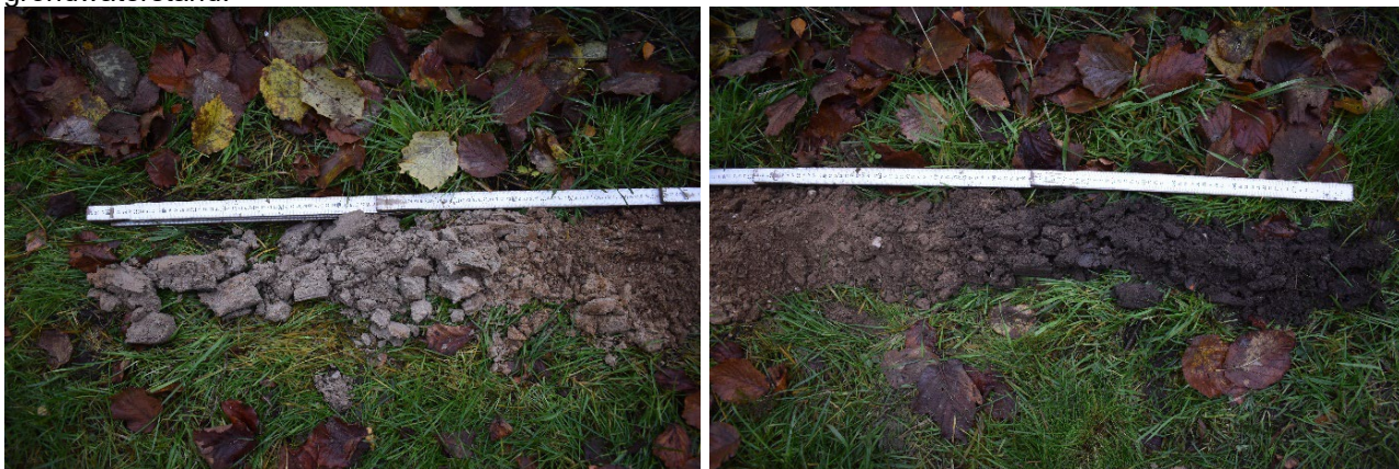
Afbeelding 4.1 en 4.2: Het profiel van boring 2. De bovenzijde bevindt zich uiterst rechts (bron: Greenhouse Advies bv, opnamedatum: 09-12-2022).
