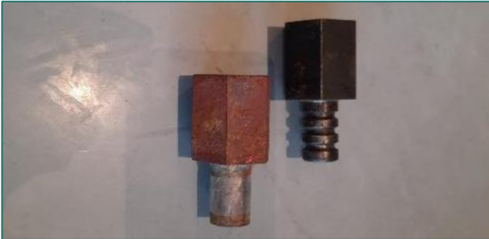
Figuur 32. Impressie stalen valgewichten (bron: REASeuro).
