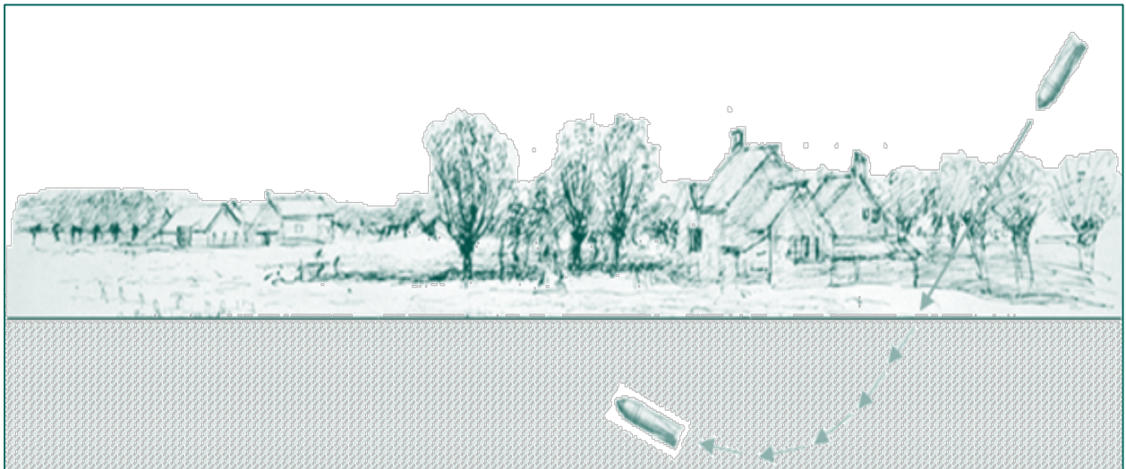
Figuur 28. Ondergrondse baan vliegtuigbom.
