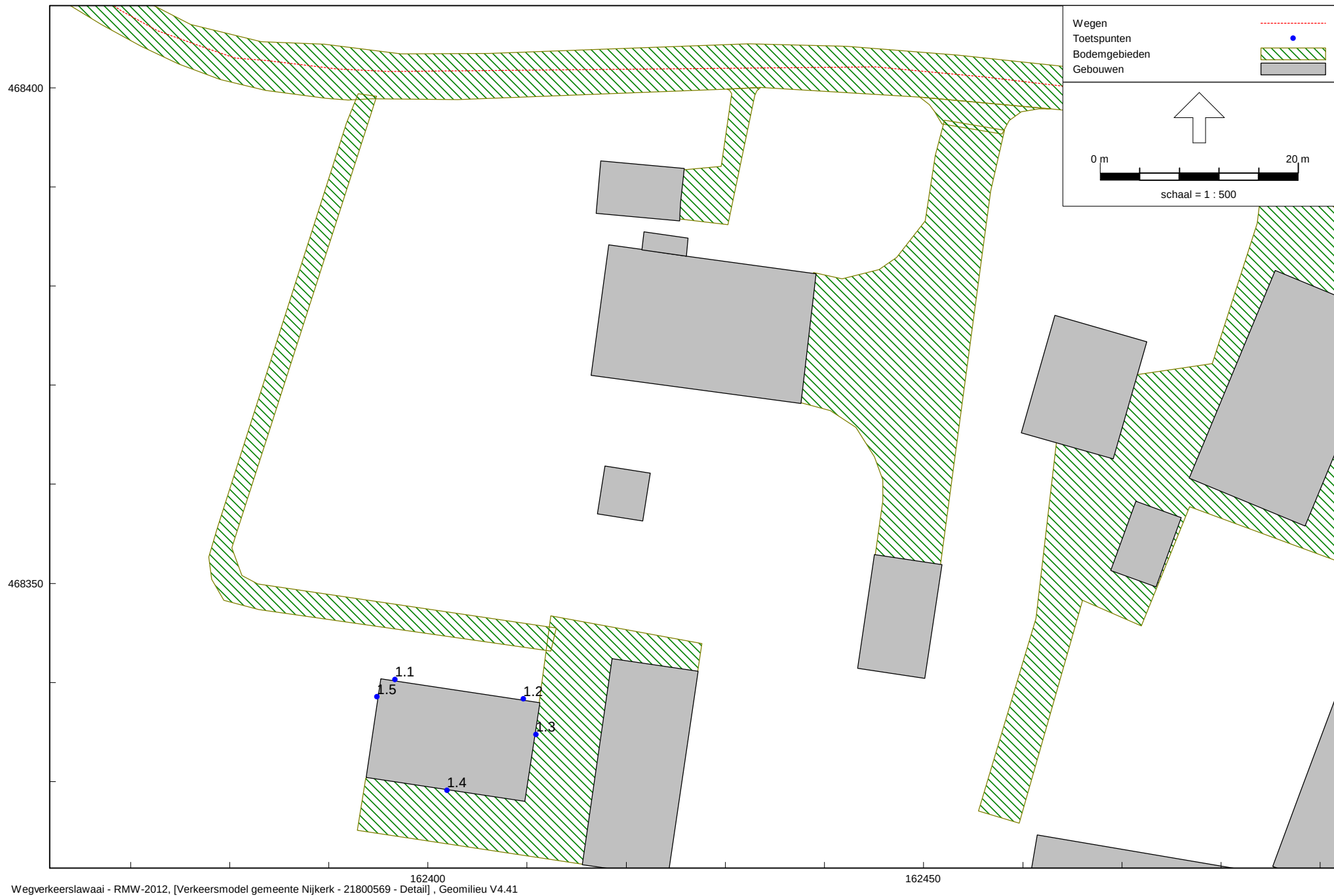
Bouwplan Slichtenhorsterweg 65 in Nijkerk Akoestisch rekenmodel wegverkeer: ingevoerde rekenpunten
