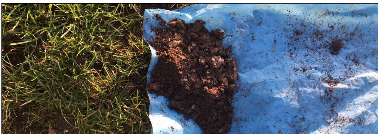
Boring 6, één van de 5 pogingen gezet in een straal van circa 10 m rondom het boorpunt. Meermaals gestaakt in beton en rood/oranje baksteen. Ook representatief voor boringen 6 en 8.
