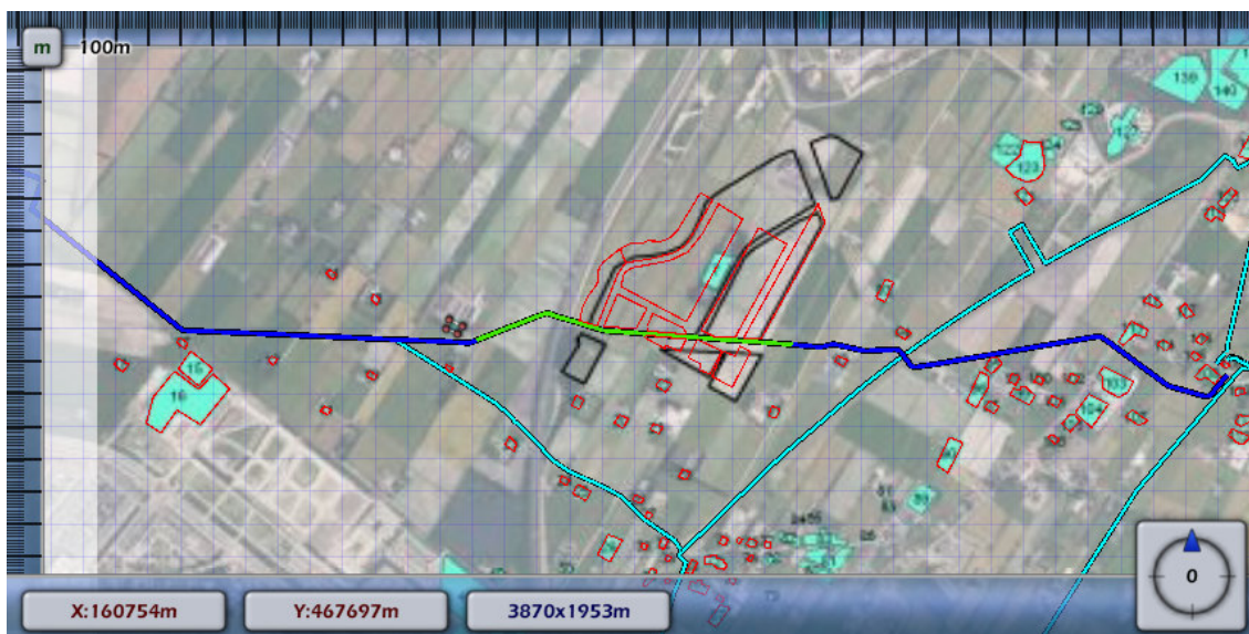
Afbeelding 18. Kilometer leiding met hoogste overschrijdingsfactor ten opzichte van de oriënterende waarde bij 40 pers. per hectare.
