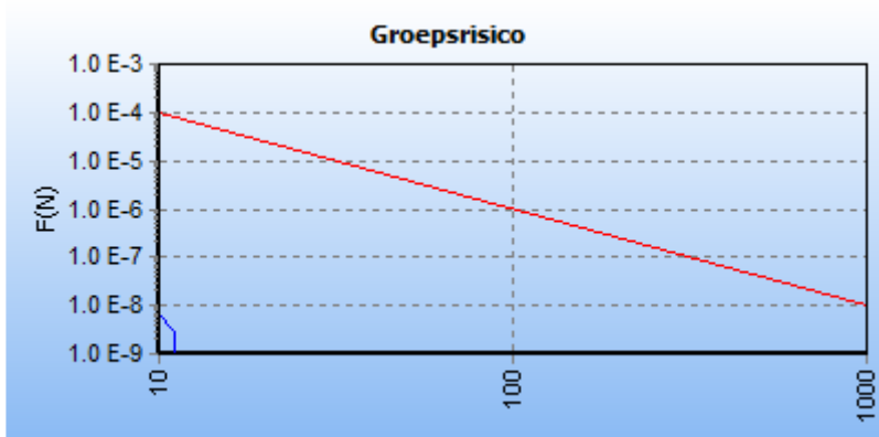
5.2 Figuur 5.2 FN curve voor 7817_leiding-W-531-03-deel-1 van N.V. Nederlandse Gasunie voor de kilometer tussen stationing 3460.00 en stationing 4460.00
