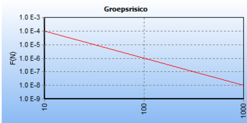
5.2 Figuur 5.2 FN curve voor 7817_leiding-W-531-03-deel-1 van N.V. Nederlandse Gasunie voor de kilometer tussen stationing 3460.00 en stationing 4460.00
