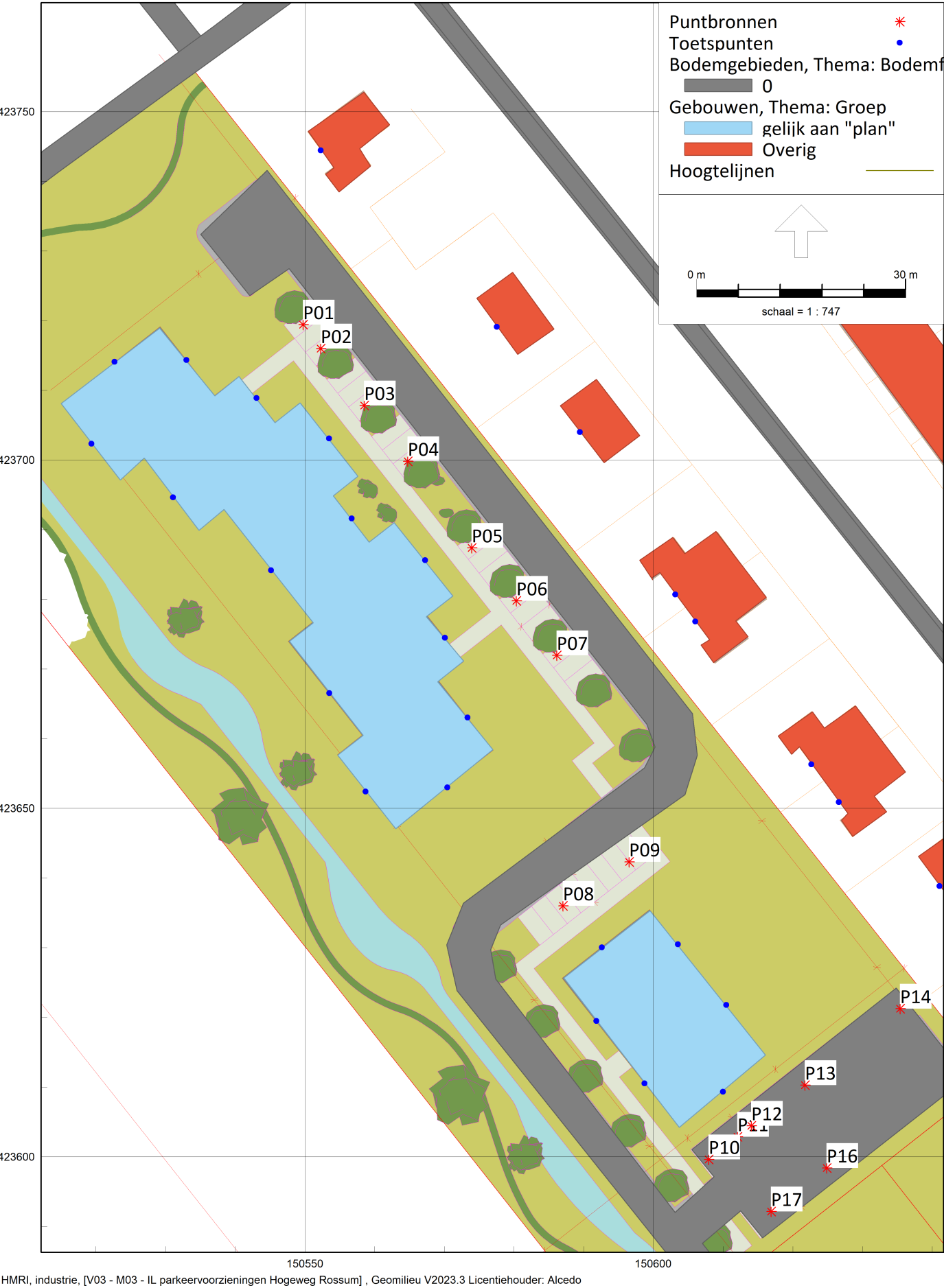
Figuur 4 | Posities geluidsbronnen dichtslaande portieren
