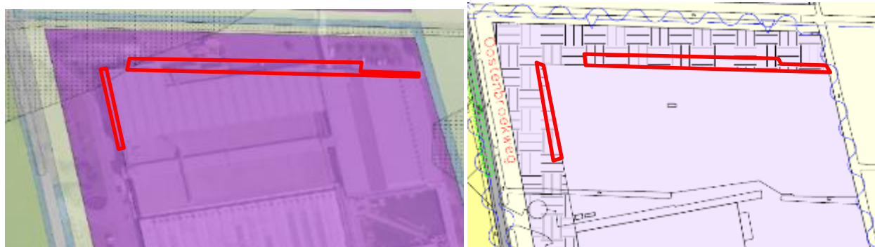
Figuur 2.5 Discrepancie tussen bouwvlak en aanwezige bebouwing noordzijde Oostenbroekweg 19.
