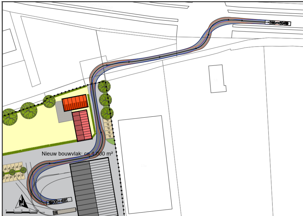
Figuur 3 Rijcurventoets uitgaand vrachtverkeer
