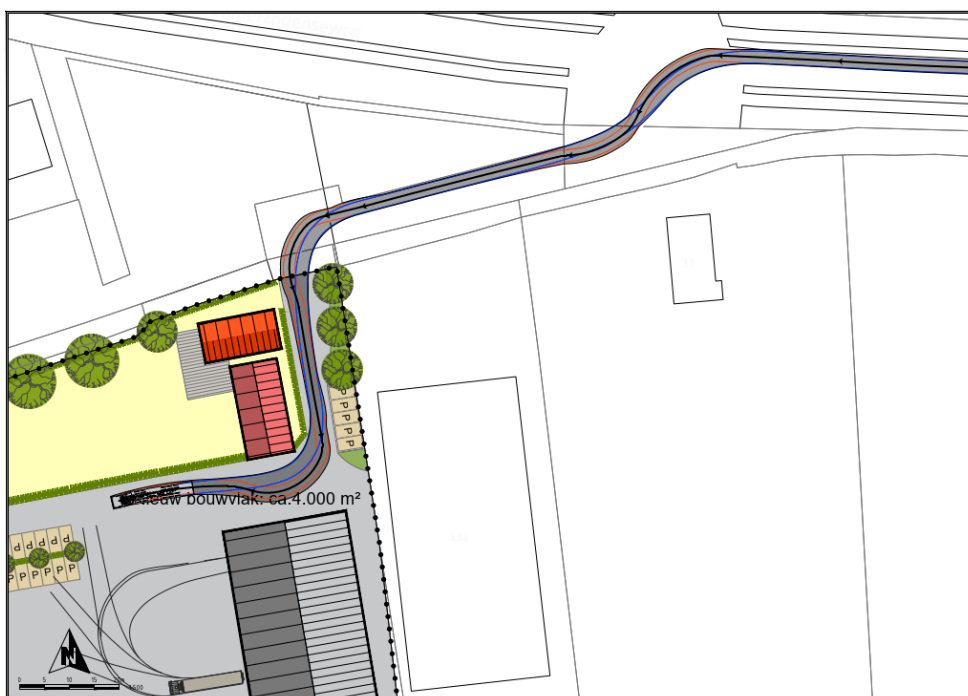
Figuur 2 Rijcurventoets ingaand vrachtverkeer
